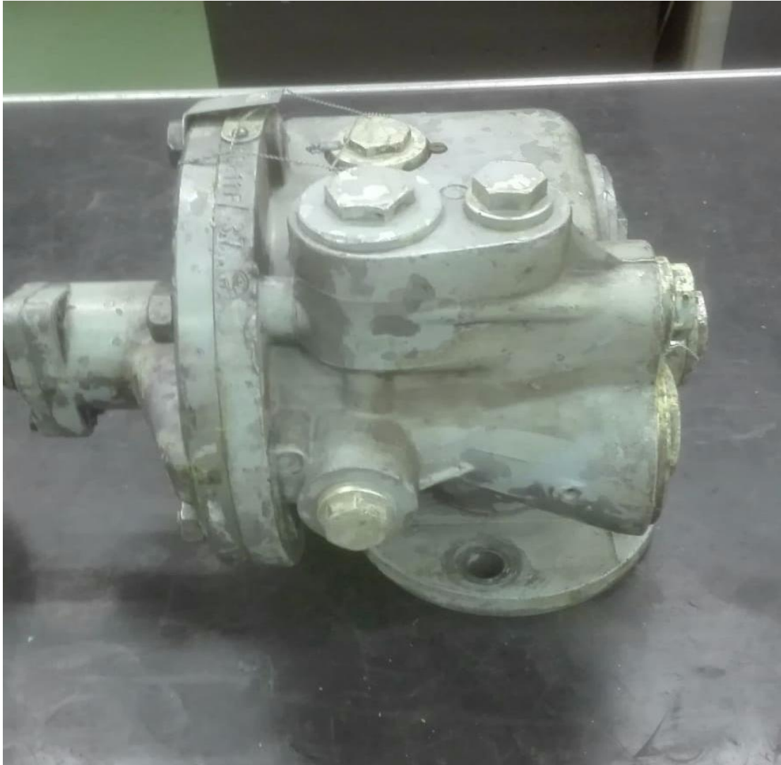
Slika 7: Rasporednik zračne kočnice Est4e [7]
