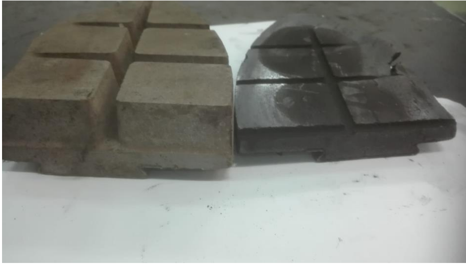
Slika 14: Nova i istrošena kočiona papuča [14]
