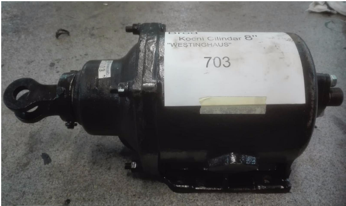
Slika 8: Kočioni cilindar spreman za ugradnju [8]
