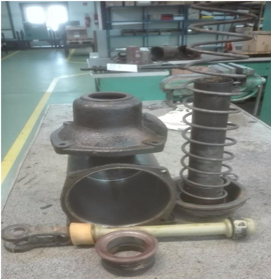
Slika 9: Kočioni cilindar prije servisa [9]
