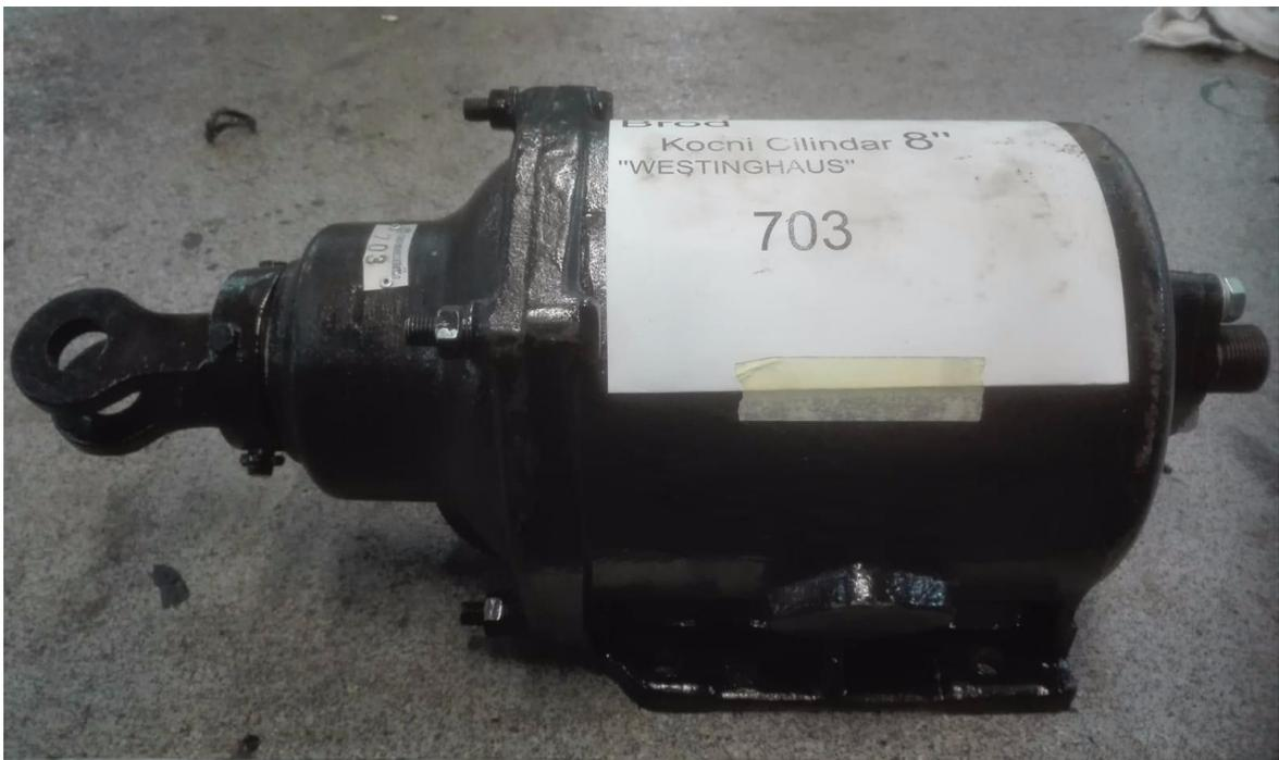
*Slika 8: Kočioni cilindar spreman za ugradnju [8]*
