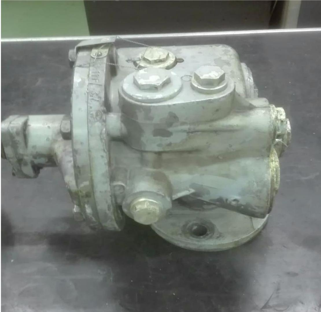
*Slika 7: Rasporednik zračne kočnice Est4e [7]*
