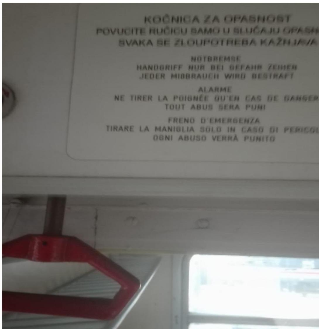
*Slika 16: Poluga ručne kočnice [16]*
