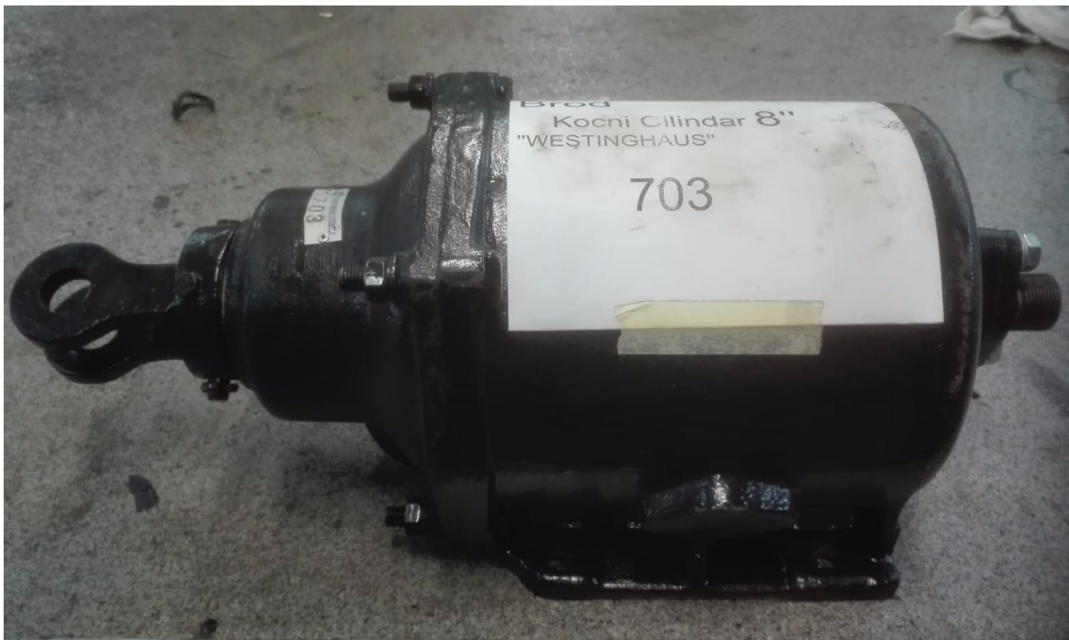
Slika 8: Kočioni cilindar spreman za ugradnju [8]
