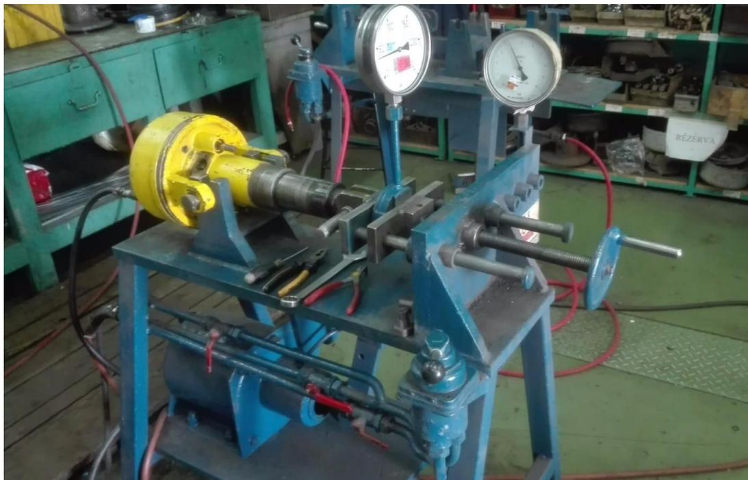
*Slika 17: Ispitivanje automatskog kočenja s pritiskom od 5 bara [17]*
