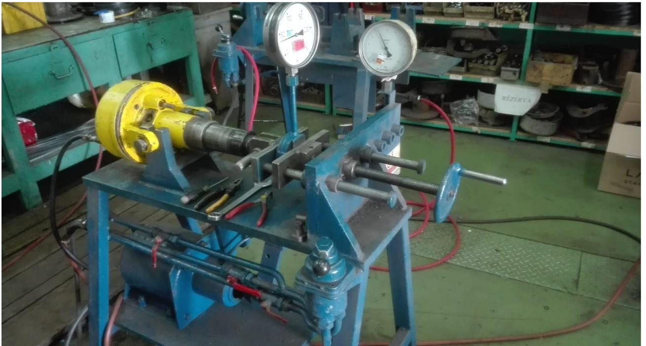
*Slika 1: Mehanička probnica za ispitivanje rasporednika [1]*
