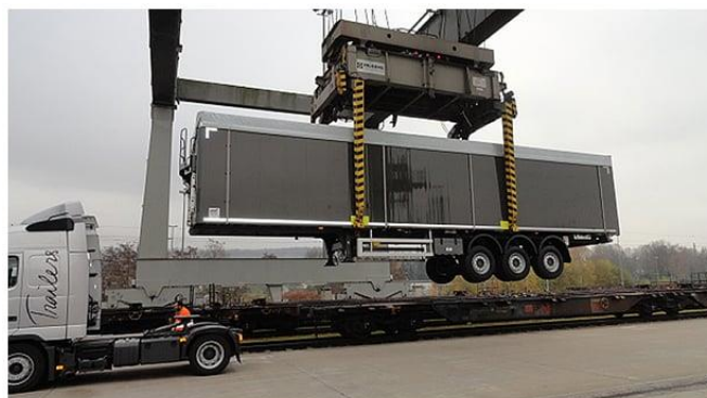
Slika 25. Huckepack tehnologija B
