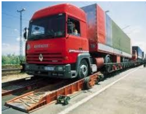
Slika 24. Huckepack tehnologija A
