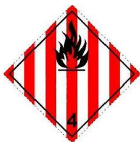
Slika 5 : Listica opasnosti zapaljivih čvrstih tvari
