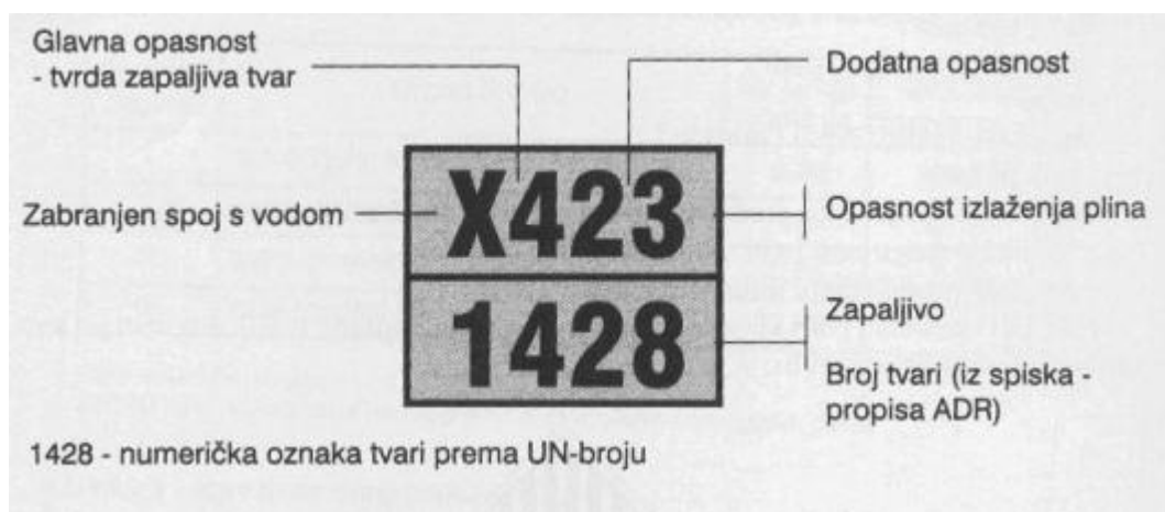
Slika broj 15: Značenje brojeva na listici opasnosti
