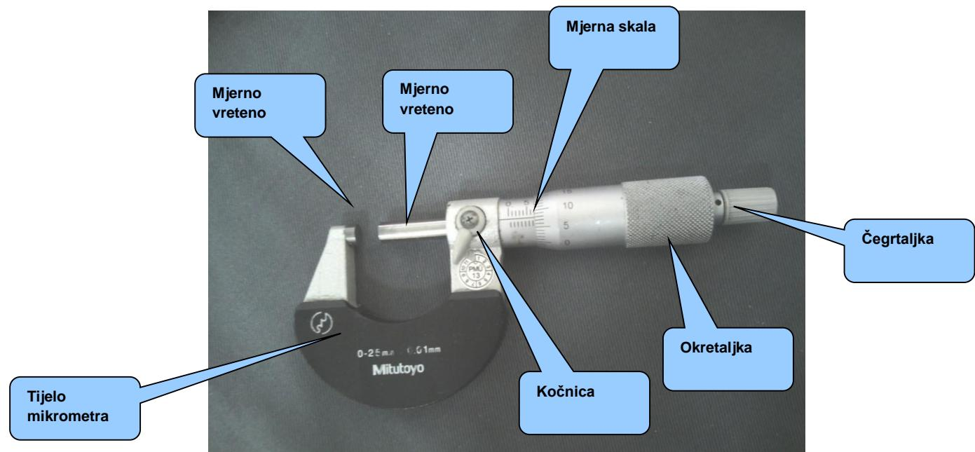
Slika 2. Mikrometar
