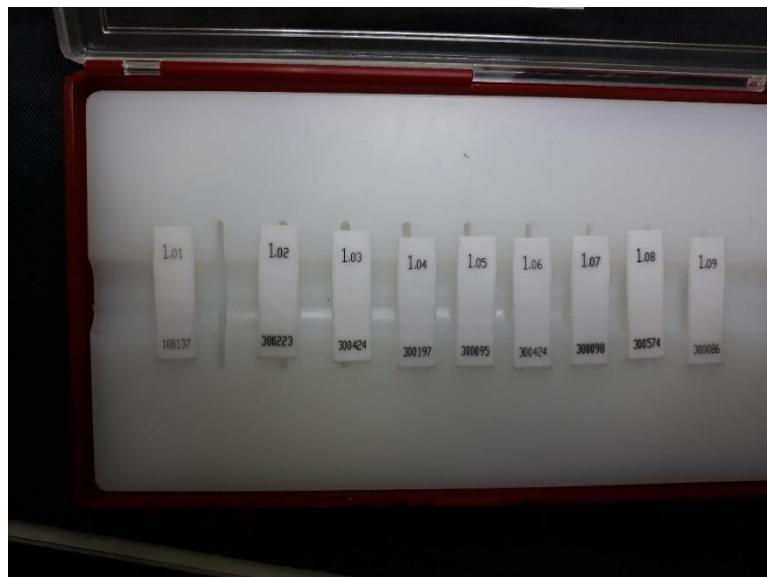
Slika 30. Set za kalibraciju mjernih ura BN 0004
