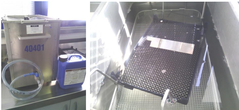
Slika 55. Postavljanje komada za ultrazvučnu kupku
