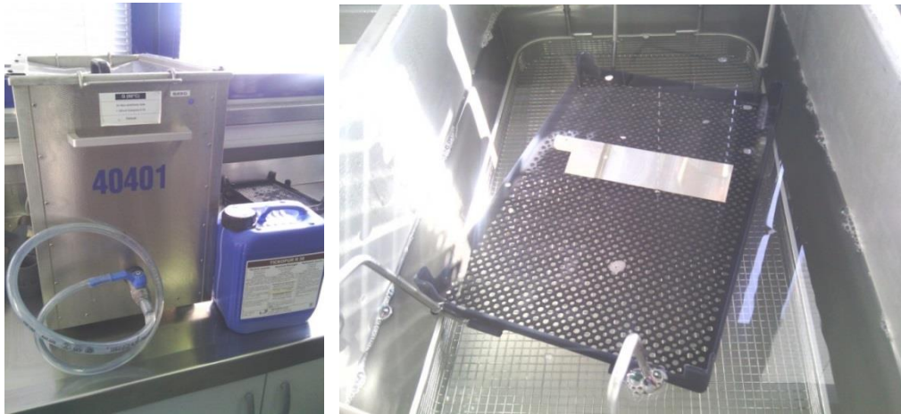
Slika 55. Postavljanje komada za ultrazvučnu kupku
