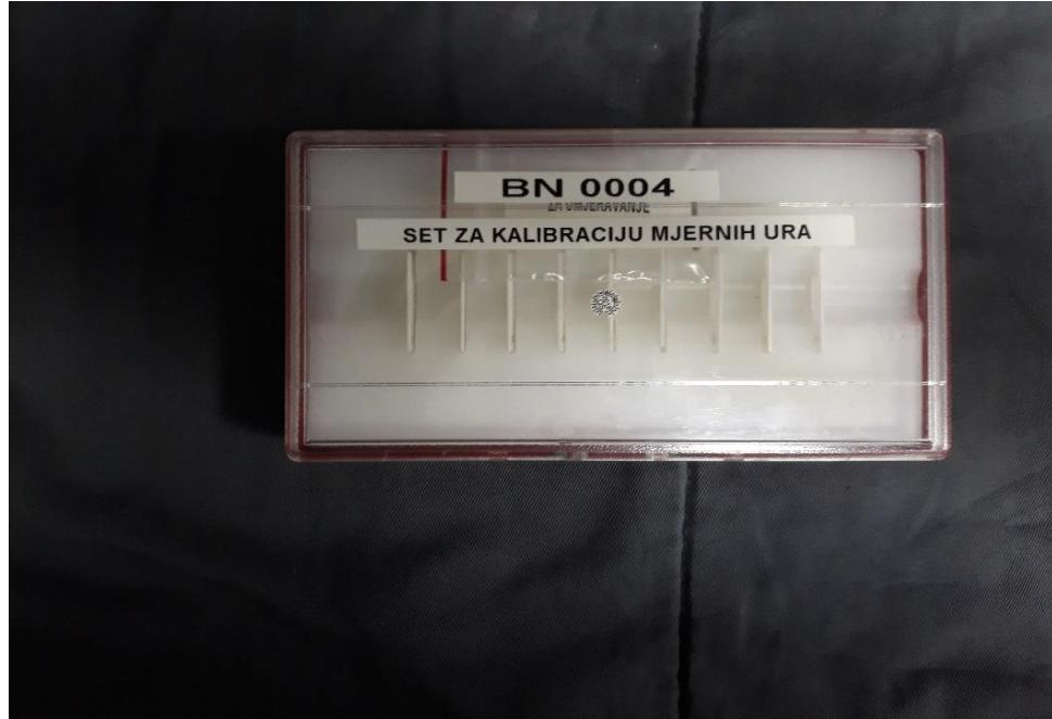
Slika 29. Set za kalibraciju mjernih ura BN 0004
