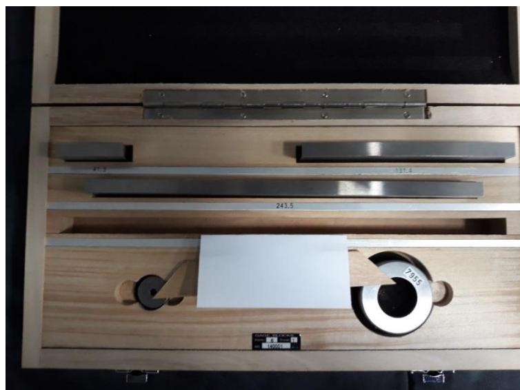
Slika 32. Set za kalibraciju pomičnih mjerila 0 - 300 mm BN 0005
