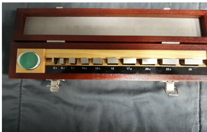
Slika 26. Set za kalibraciju mikrometra BN 0001
