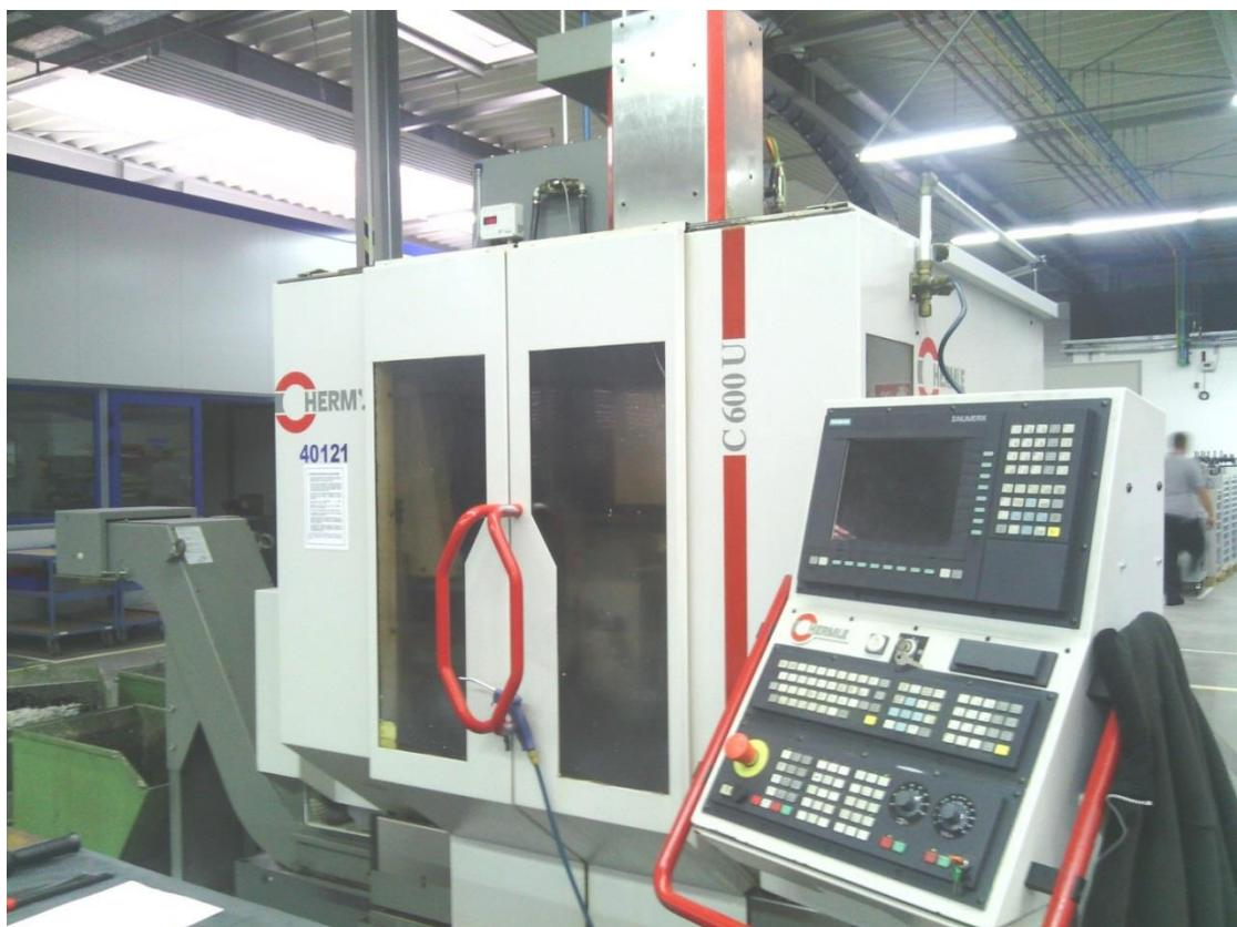
Slika 46. CNC glodalica
