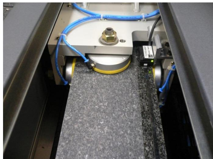
Slika 17. Zračni ležajevi
