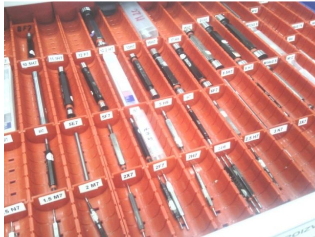
Slika 6. Granični kontrolni trnovi
