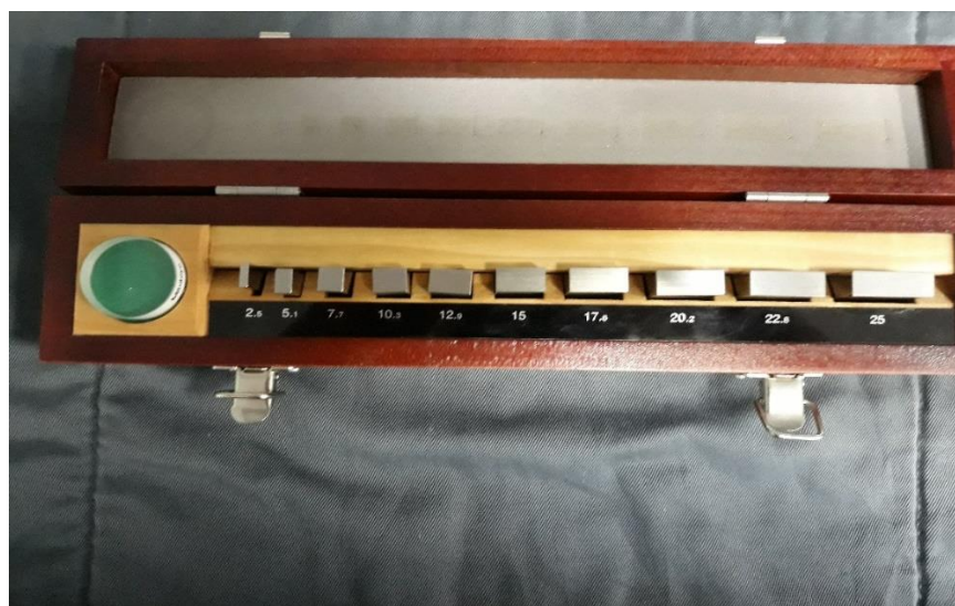
Slika 26. Set za kalibraciju mikrometra BN 0001
