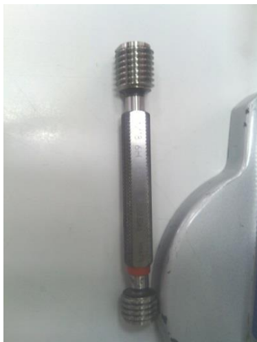
Slika 8. Granični kontrolni navoj
