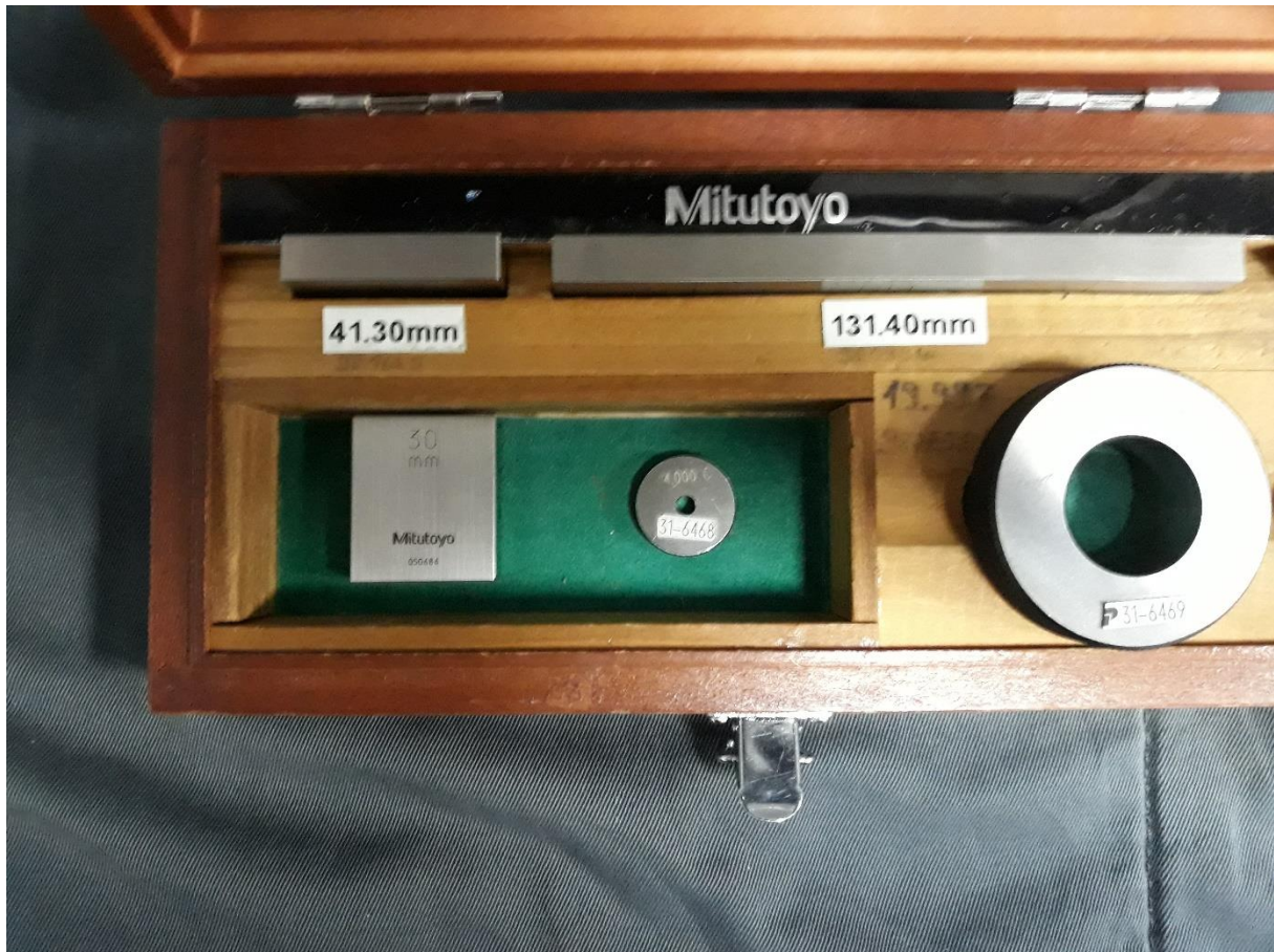
Slika 31. Set za kalibraciju pomičnih mjerila 0 - 150 mm
