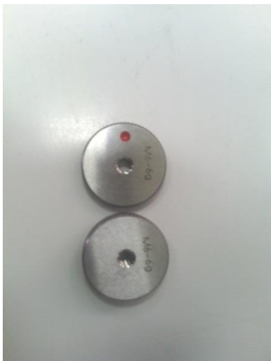
Slika 11. Navojna kontrolna matica
