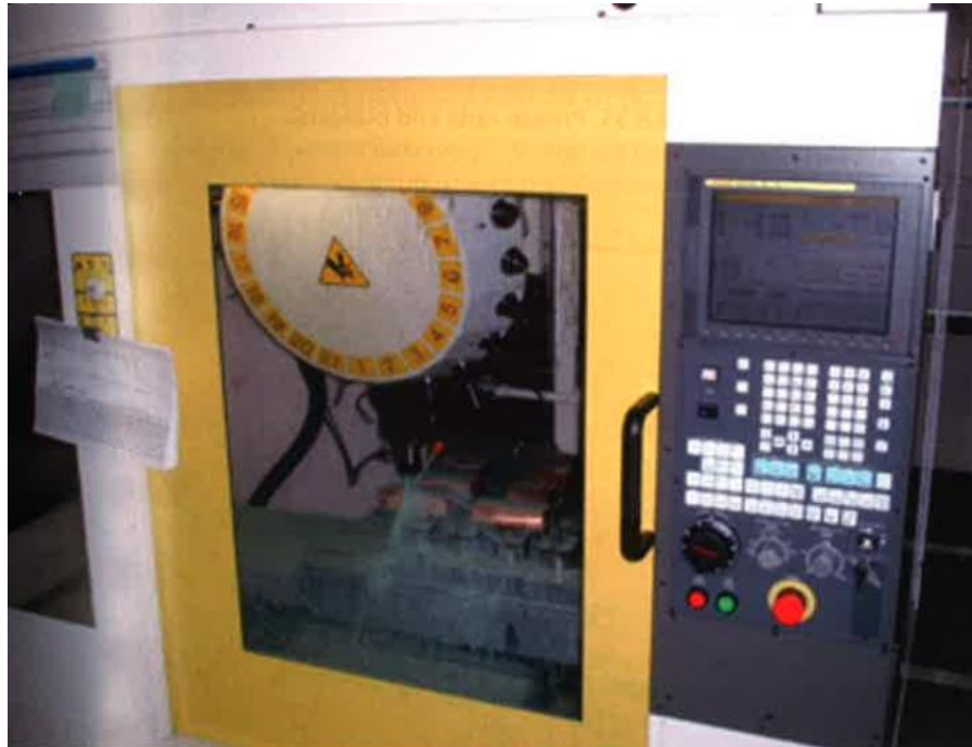
Slika 5.14 CNC bušilica sa zatvorenim prostorom i vlastitim skladištem alata [1]
