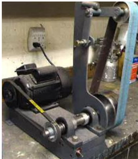
Slika 5.4 Tračna brusilica u proizvodnom pogonu [1]
