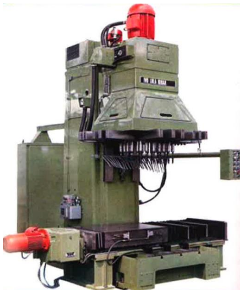
Slika 5.9 Izgled viševretene bušilice [1]
