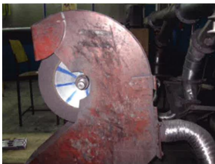
Slika 5.6 Uređaj za odsisavanje prašine izrađen u kombinaciji sa zaštitnim oklopom [1]
