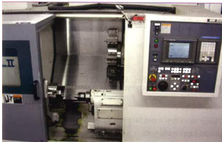
Slika 5.30 CNC tokarilica sa zatvorenim sustavom [1]
