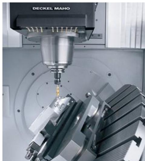
Slika 13 Obrada komada na okretno-nagibnom stolu [10]
