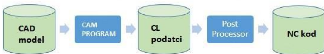
Slika 24 Postprocesor u proizvodnom ciklusu [12]
