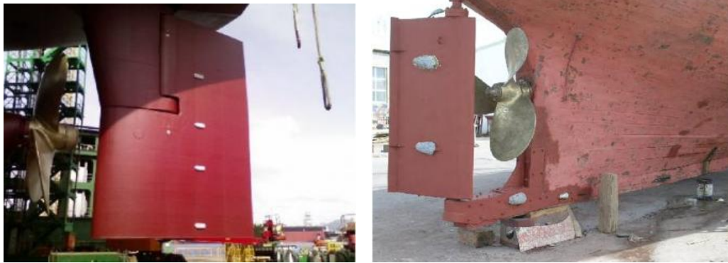
Slika 13. Primjeri katodne zaštite cinkovim protektora[7]
