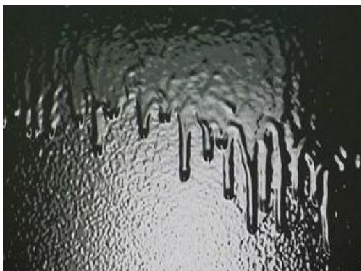
Slika 34. "Curci" na metalnoj površini[17]
