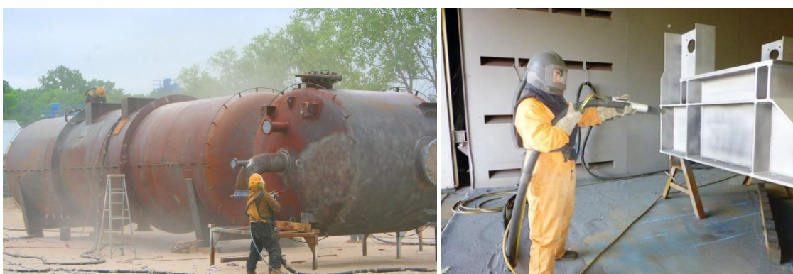
Slika 28. Priprema površine pjeskarenjem [37, 38]
