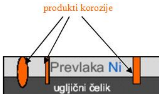
Slika 18. Katodna prevlaka nikla na čeliku[9]
