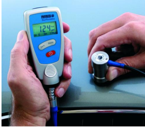
Slika 36. Uređaj za mjerenje debljine suhog filma[41]
