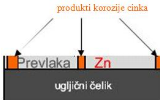
Slika 20. Anodna prevlaka cinka na željezu[9]
