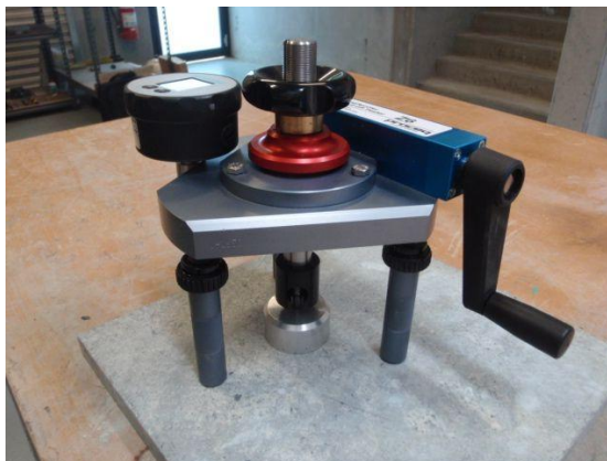
Slika 37. Slika sprave za ispitivanje kvalitete premaza[42]
