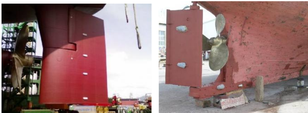
Slika 13. Primjeri katodne zaštite cinkovim protektora[7]
