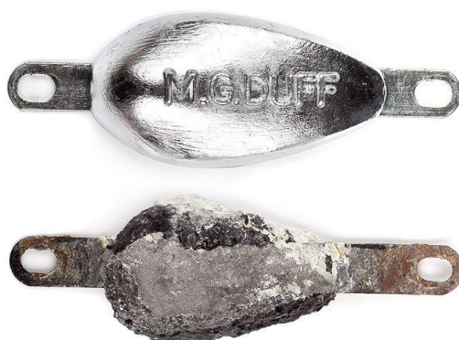
Slika 12. Primjeri istrošenih anoda[32]
