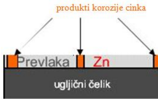
Slika 20. Anodna prevlaka cinka na željezu[9]
