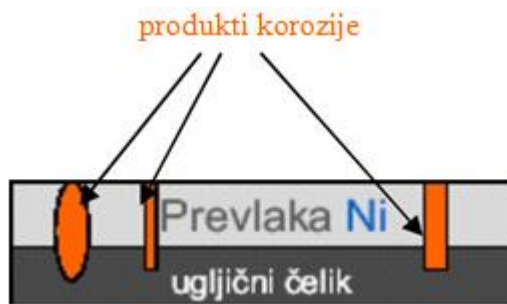
Slika 18. Katodna prevlaka nikla na čeliku[9]
