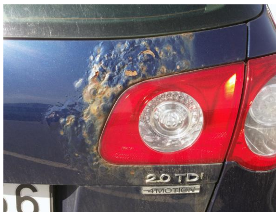
Slika 6. Potpovršinska korozija na automobilu [26]
