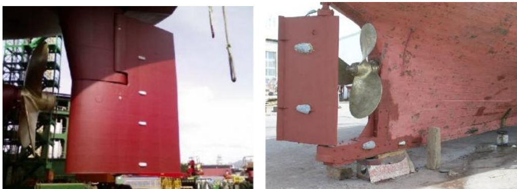
Slika 13. Primjeri katodne zaštite cinkovim protektora[7]
