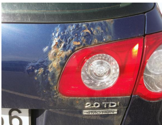
Slika 6. Potpovršinska korozija na automobilu [26]
