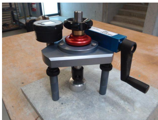
Slika 37. Slika sprave za ispitivanje kvalitete premaza[42]
