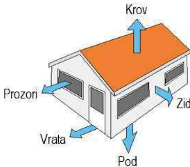
Slika 4.1 Ilustracija prijelaza topline iz prostorije
