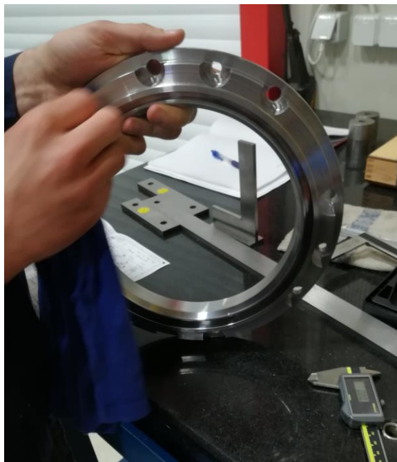
Slika 8.11 Čišćenje predmeta mjerenja prije mjerenja
