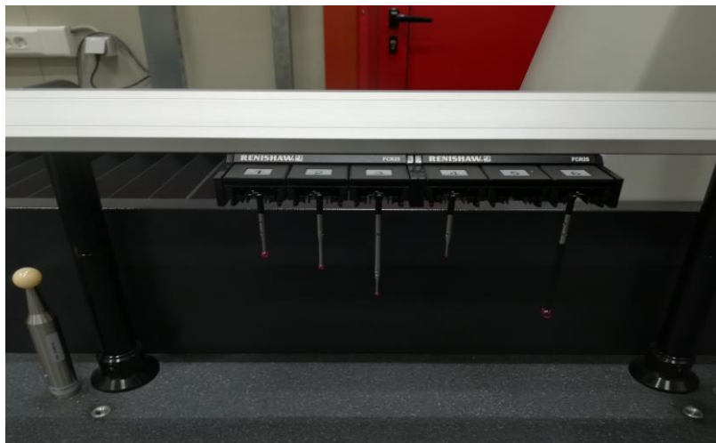
Slika 8.7 Kugla za umjeravanje i stalak sa mjernim ticalima
