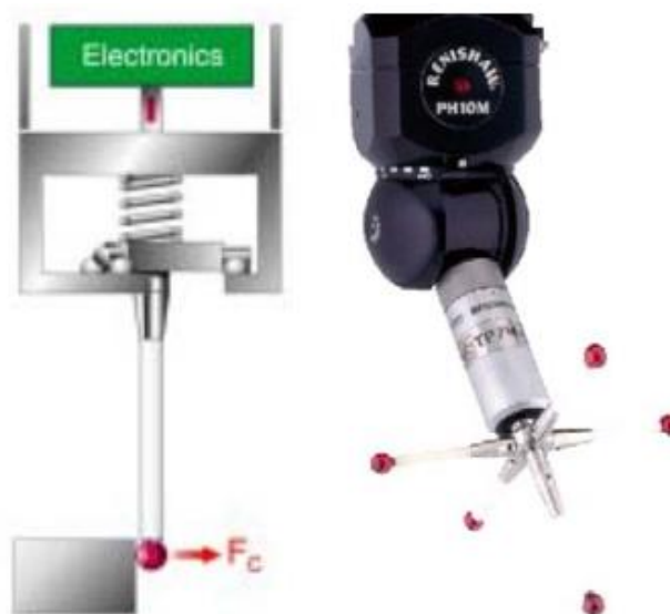
Slika 5.14 Sonda sa mjernim trakama (Renishaw TP7M) [3]
