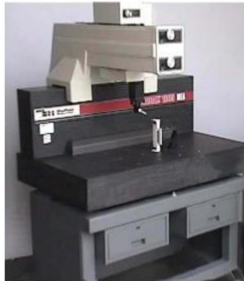
Slika 3.5 Konzolna struktura TMU-a [3]
