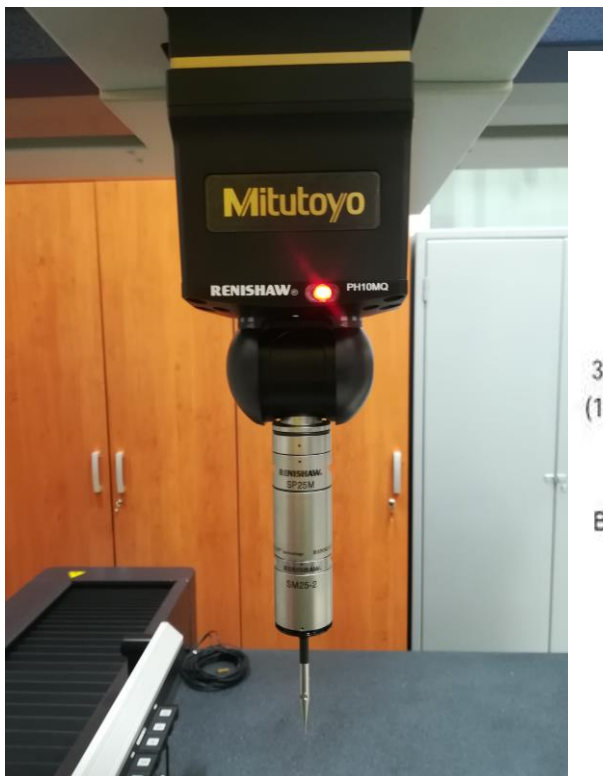
Slika 8.4 Renishaw PH10MQ mjerna sonda
