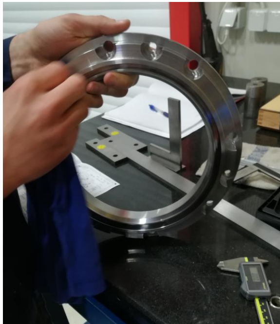
Slika 8.11 Čišćenje predmeta mjerenja prije mjerenja
