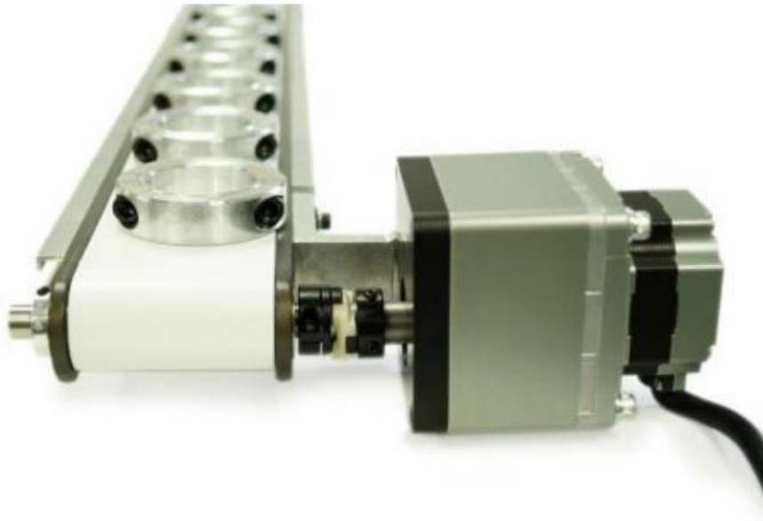
Slika 1.3 Primjena Oldhamove spojke u proizvodnji
