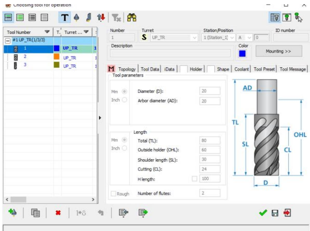
Slika 6.11 Korišteno glodalo (promjer  $\phi 20$  mm) [21]
