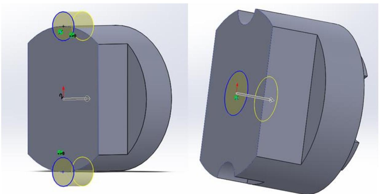
Slika 6.6 Bušenje rupa na dubinu od 15 mm [20]
