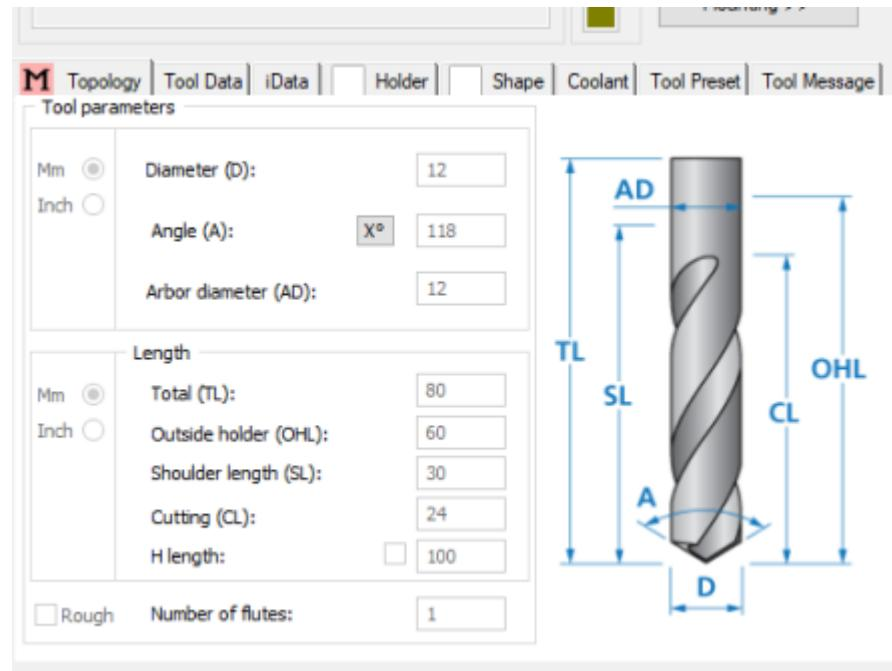
Slika 6.15 Srvdlo korišteno kod bušenja [21]
