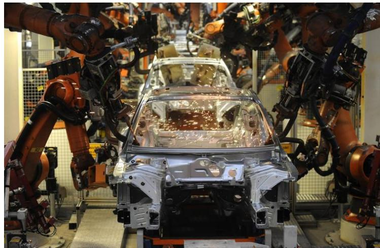
*Slika 3.2. Roboti za zavarivanje u automobilskoj industriji [8]*
