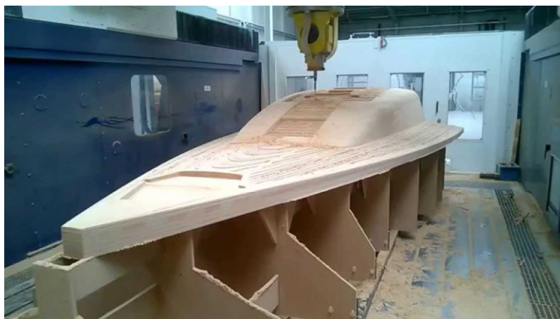
Slika 3.9 Glodanje palube broda [12]
