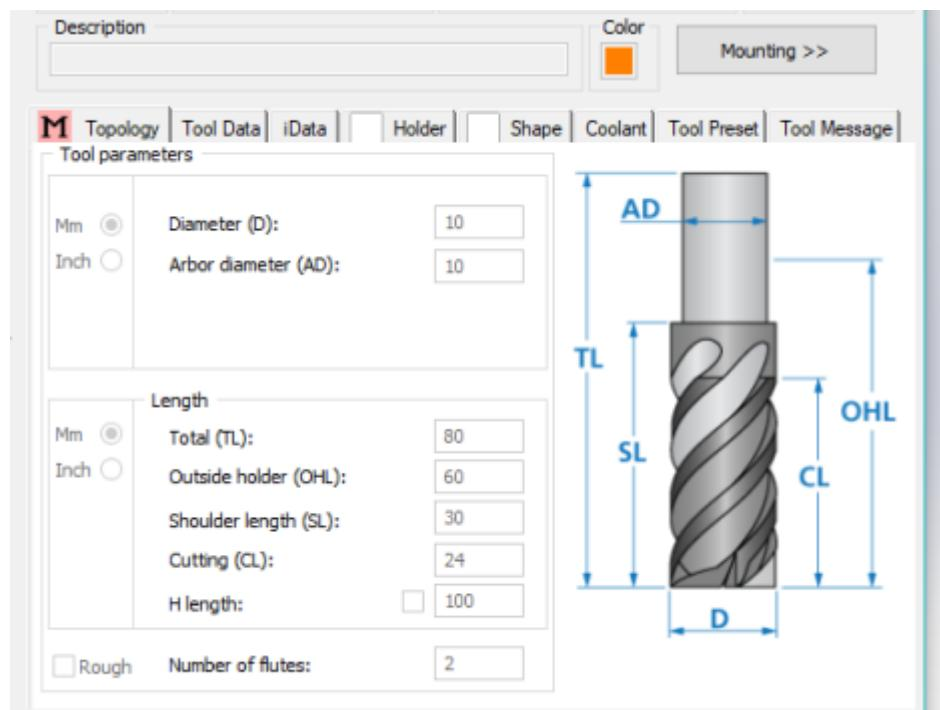
Slika 6.13 Glodalo promjera  $\phi 10$  mm [21]
