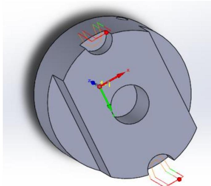
Slika 6.20 Drugo glodanje bočnih strana obradka alatom  $\phi 10$  mm [21]
