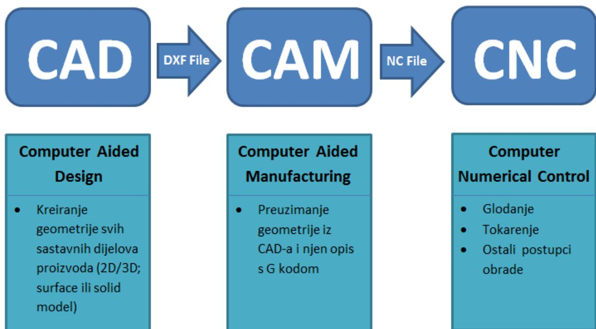
Slika 4.1 CAD/CAM sustavi [13]
