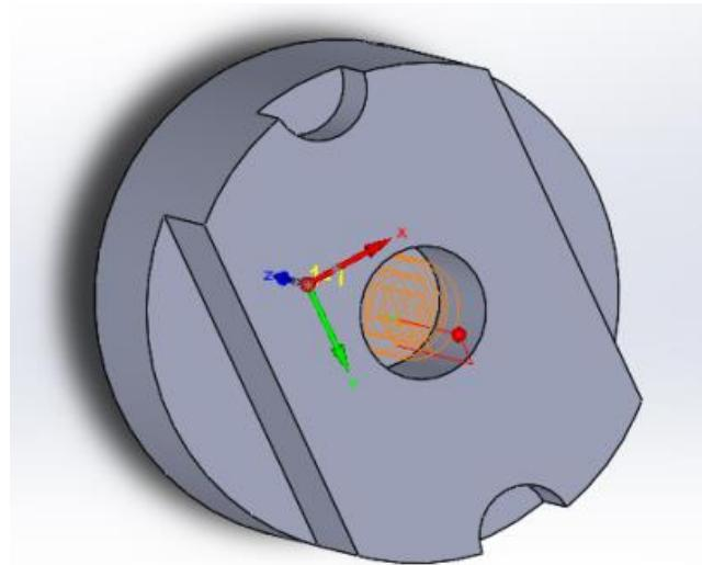
Slika 6.21 Treće glodanje sredine obradka alatom  $\phi$  10mm [21]
