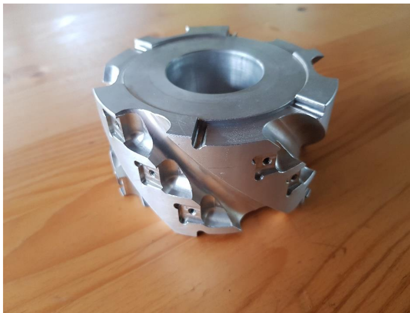
Slika 7-17. Konačni izgled glodala
