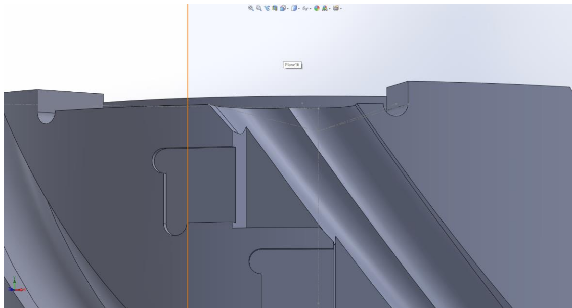
Slika 4-14. Izrada utora za pločice
