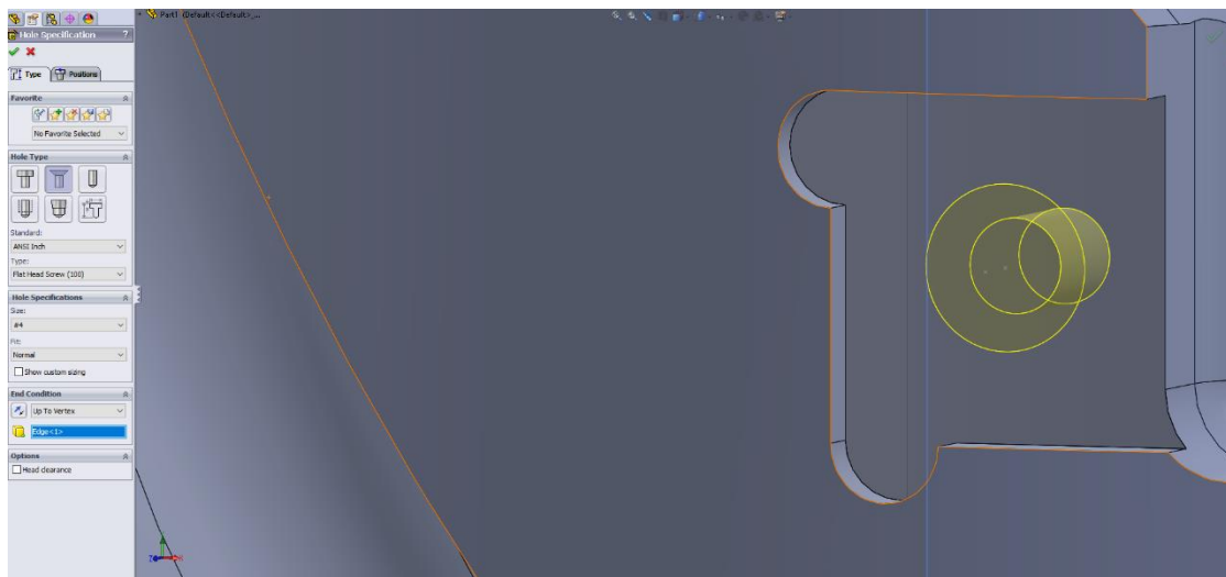
Slika 4-15. Izrada rupa sa navojem
