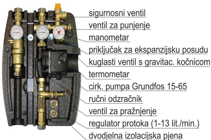
Slika 7.6.1. Elementi solarne pumpne grupe CSPG-260 [12]
