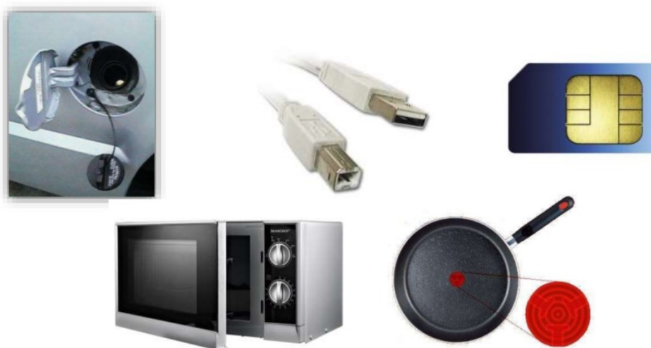
Slika 4.1 Primjeri Poka Yoke metode
