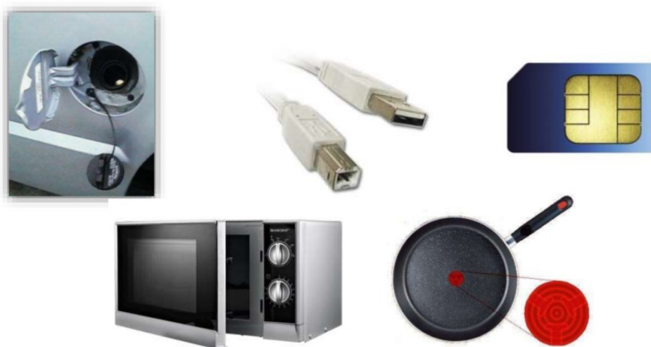
Slika 4.1 Primjeri Poka Yoke metode
