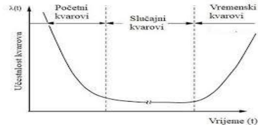
Slika 4: Kvarovi na većem broju istovrsnih elemenata nekog tehničkog sistema [3]
