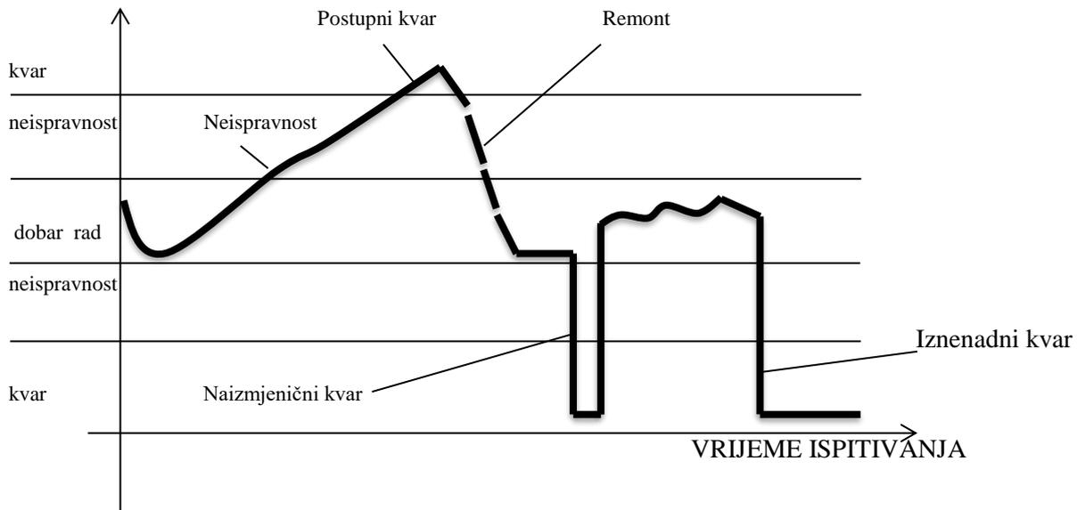
**Slika 5: Dijagram prikazuje moguća stanja elemenata i strukture tehničkog sistema, koji određuju radnu sposobnost ili nesposobnost sistema kao cjeline, ilustrirana pomoću pojma postupnog, iznenadnog i periodičnog kvara. [4]**
