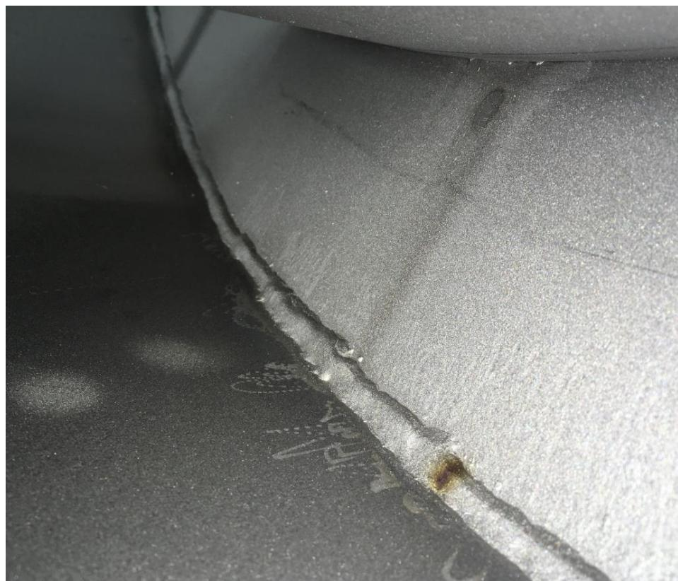
Slika 15: Pogreška oblika zavara zbog loše tehnike zavarivanja
