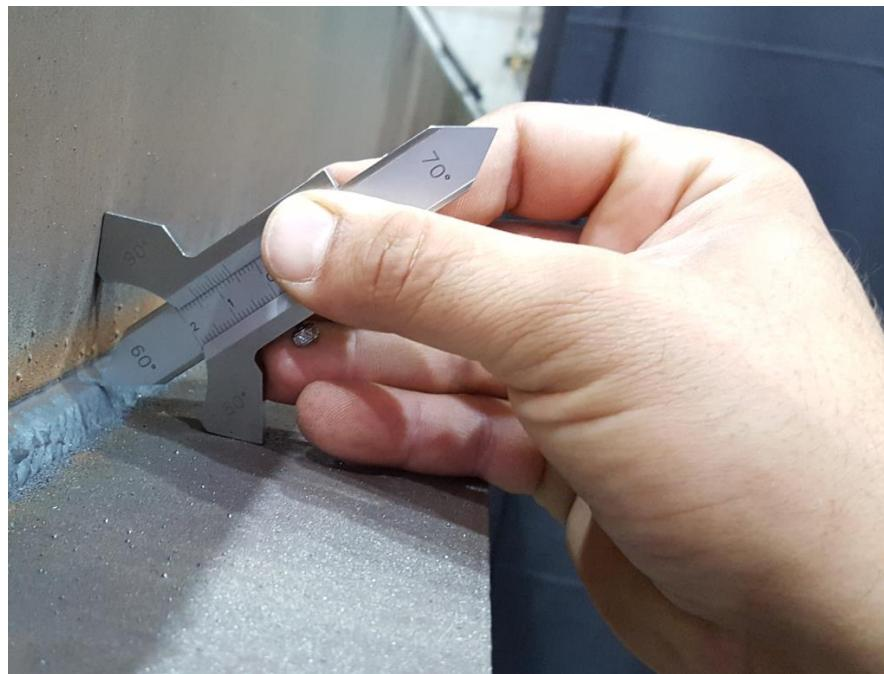
Slika 29: Mjerenje veličine zavarenog spoja
