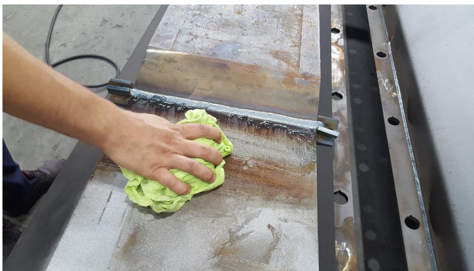
Slika 60: Završno čišćenje površine
