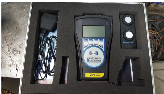
Slika 79: Lux metar SPECTROLINE XRP-3000
