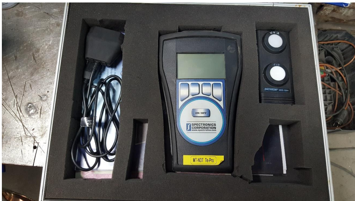
Slika 67: Lux metar SPECTROLINE XRP-3000
