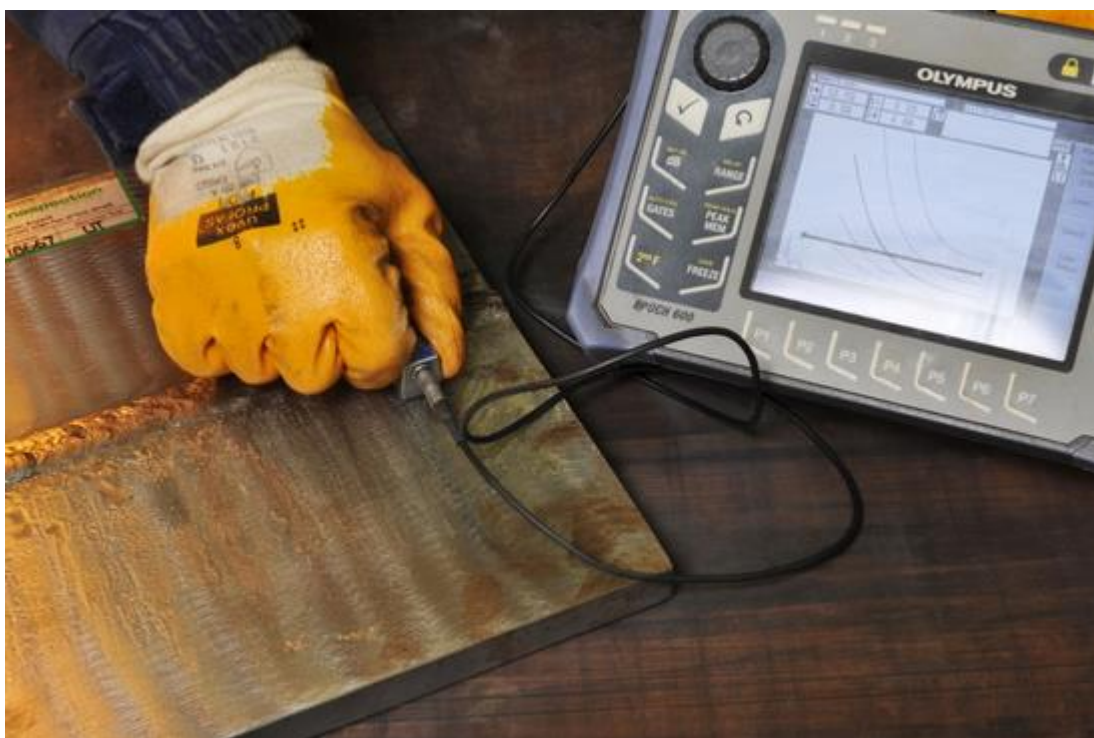
Slika 16: Ultrazvučno ispitivanje zavarenog spoja [16]
