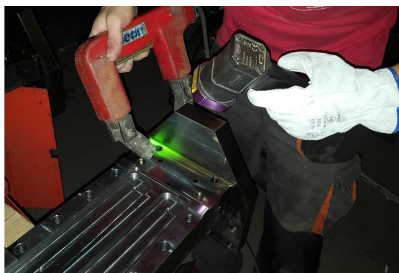
*Slika 43: Ispitivanje artikla za rudarsku industriju magnetskom metodom*
