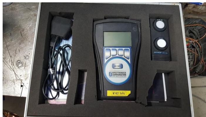
Slika 79: Lux metar SPECTROLINE XRP-3000
