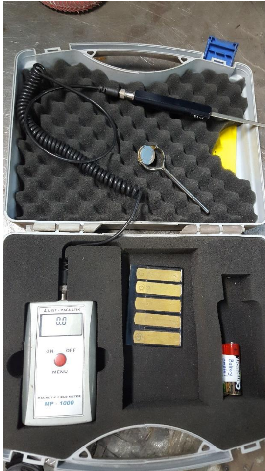
Slika 69: Magnetometar LIST MAGNETIK MP-1000
