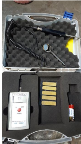
Slika 81: Magnetometar LIST MAGNETIK MP-1000
