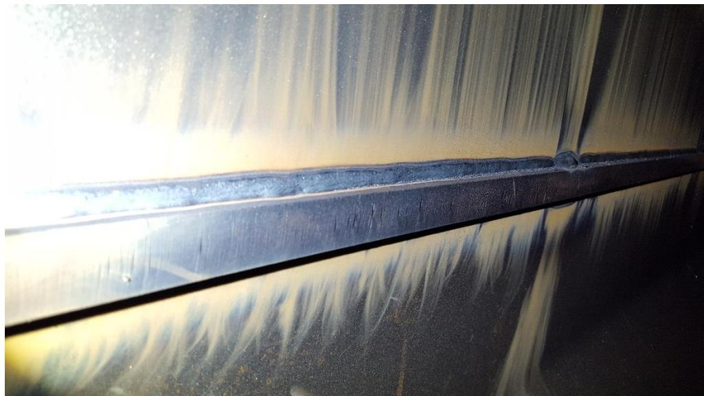
*Slika 32: Kontrola provara s unutarnje strane*
