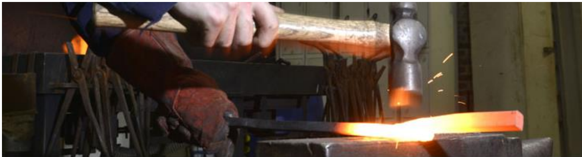
Slika 4: Prikaz kovačkog zavarivanja [24]
