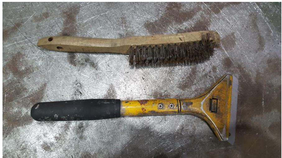
Slika 52: Alat za čišćenje površine
