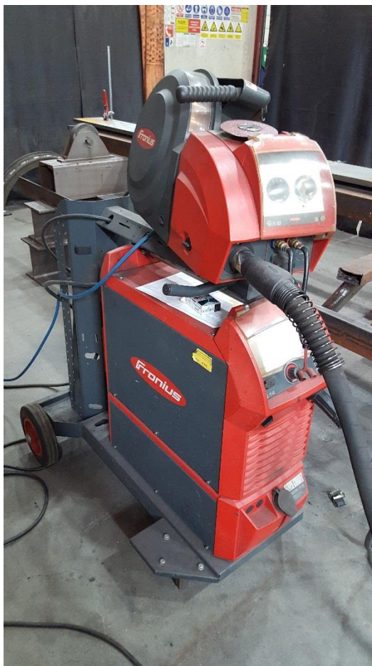
Slika 5: Moderan zavarivački aparat Fronius TPSi 500
