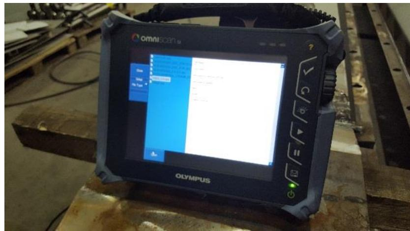
Slika 49: Aparat za provođenje ultrazvučne kontrole OLYMPUS
