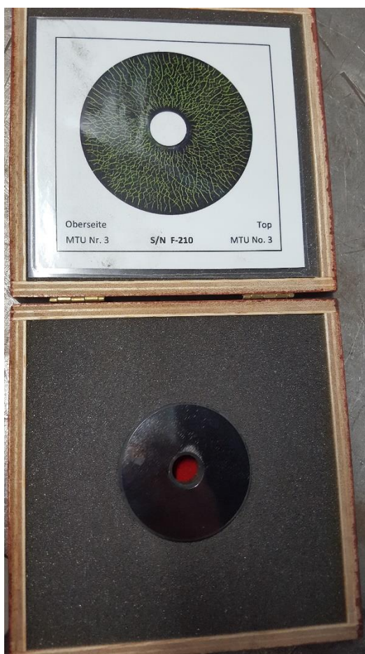
Slika 71: Suspenzija za ispitivanje magnetima Tiede 690.1
