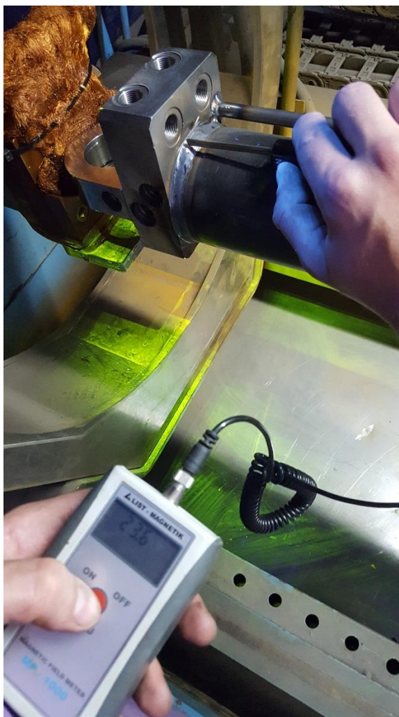
Slika 70: Rezultati dobiveni magnetometrom
