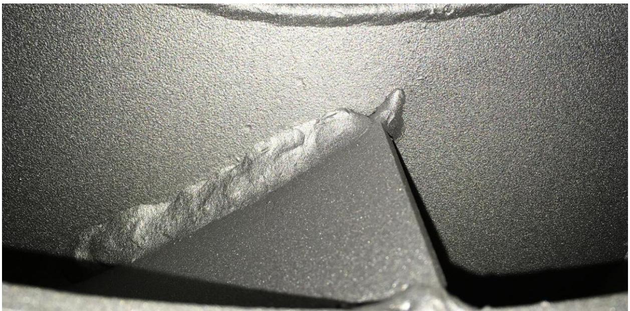
*Slika 14: Pogreška oblika zavara zbog loše tehnike zavarivanja*
