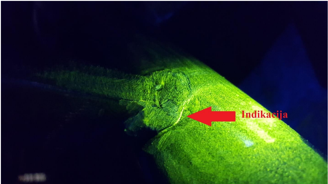
Slika 83: Indikacija otkrivena nakon što je na komad nanescena suspenzija i osvjetljena UV lampom
