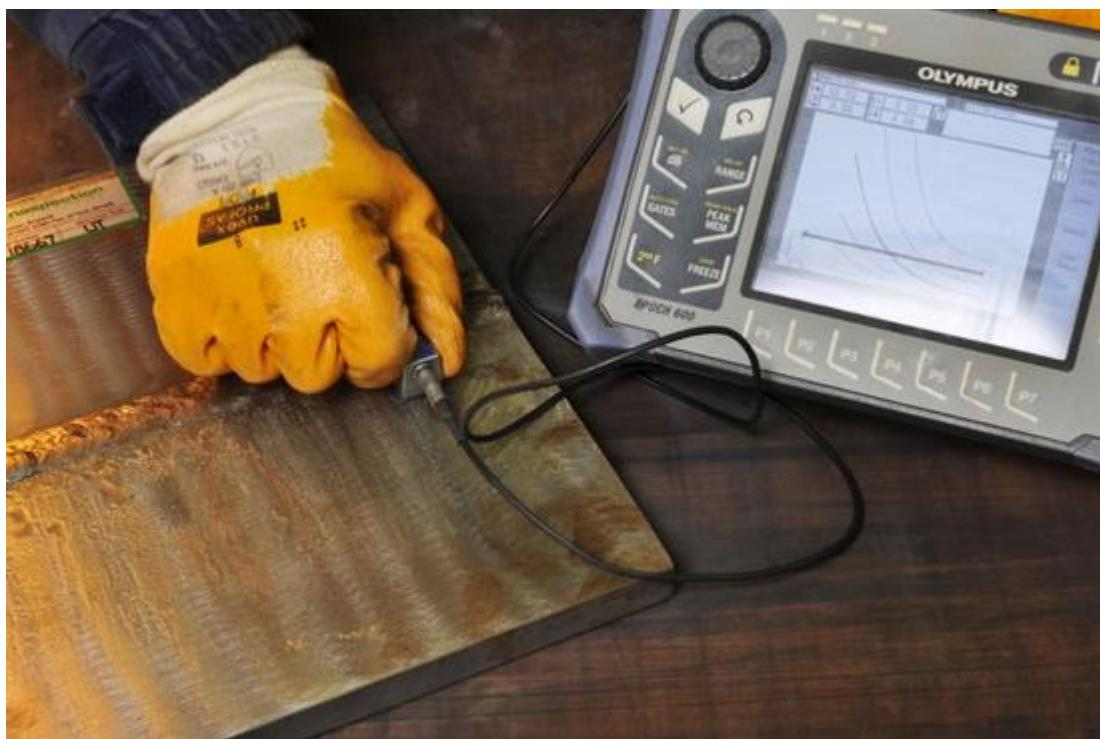
*Slika 16: Ultrazvučno ispitivanje zavarenog spoja [16]*
