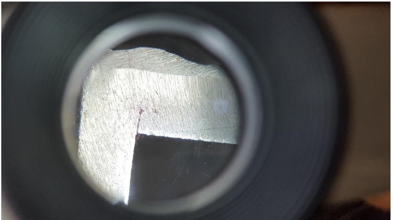
*Slika 18: Prikaz provarenosti zavarenog spoja uz pomoć povećala*
