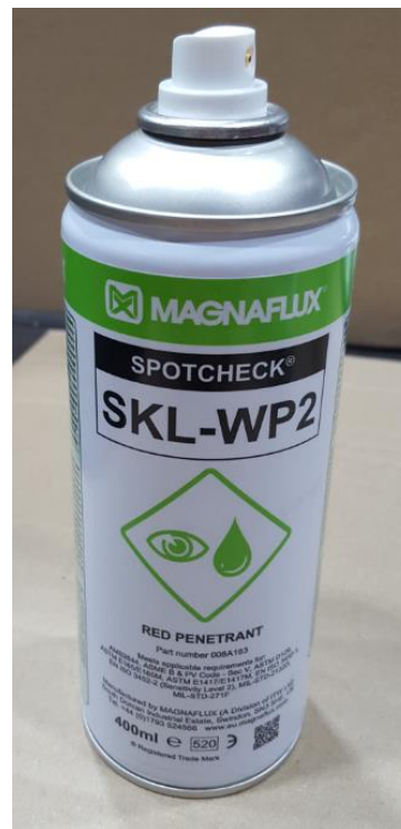
Slika 36 : Crveni penetrant Tiede SKL-WP2
