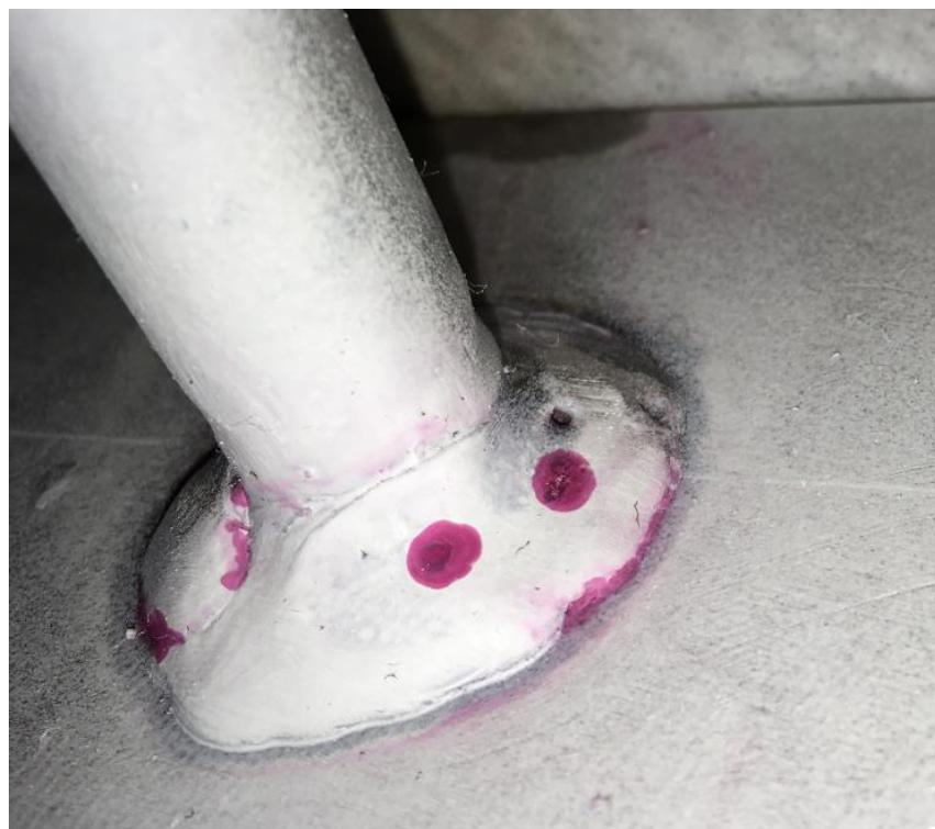
*Slika 9: Šupljine u zavarenom spoju, dio indiciran penetrantskom metodom*
