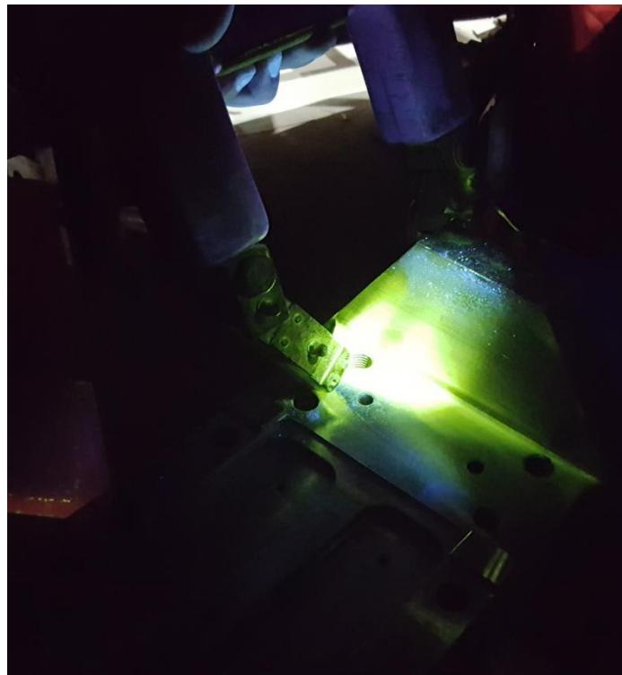
*Slika 44: Ispitivanje artikla za rudarsku industriju magnetskom metodom*
