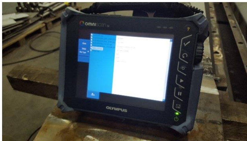
Slika 49: Aparat za provođenje ultrazvučne kontrole OLYMPUS OMNI SCAN SX
