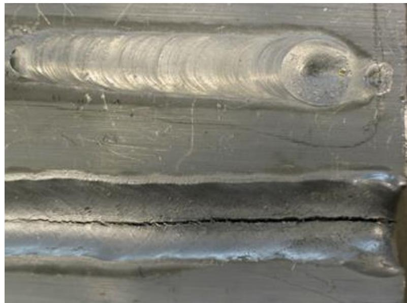
*Slika 6: Uzdužno puknuće aluminjskog zavara [14]*
