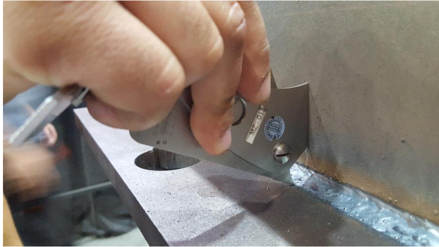
Slika 31: Mjerenje zavora s gornje strane
