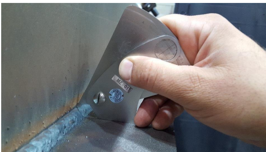
Slika 30. Mjerenje veličine zavara s donje strane
