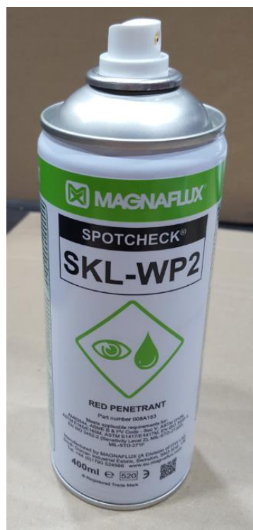
Slika 36 : Crveni penetrant Tiede SKL-WP2
