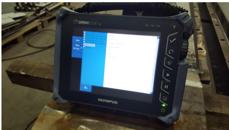
Slika 57: Unošenje parametara ispitnog predmeta (debljina materijala, vrsta materijala, brzina ispitivanja i kut)
