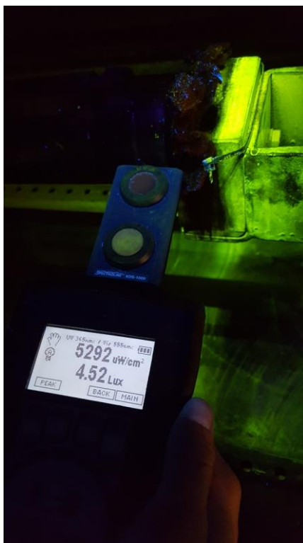
Slika 68: Rezultati mjerenja Lux metrom
