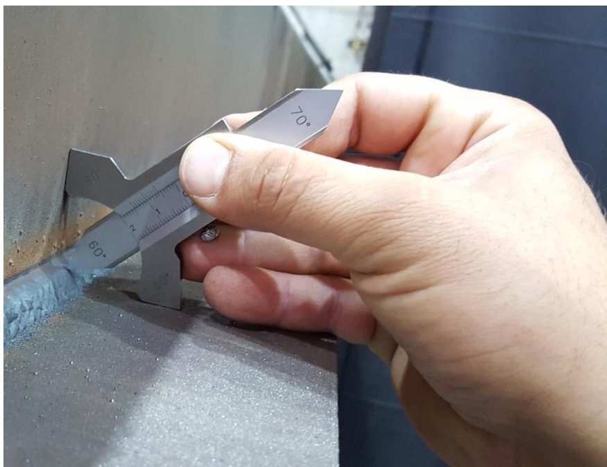
Slika 29: Mjerenje veličine zavarenog spoja
