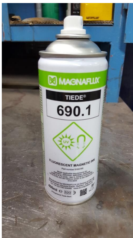
Slika 71: Suspenzija za ispitivanje magnetima Tiede 690.1
