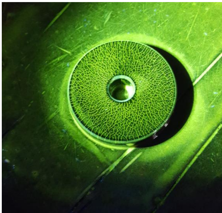
Slika 73: Referentno tijelo MTU-3 prekriveno suspenzijom i osvjetljeno UV lampom
