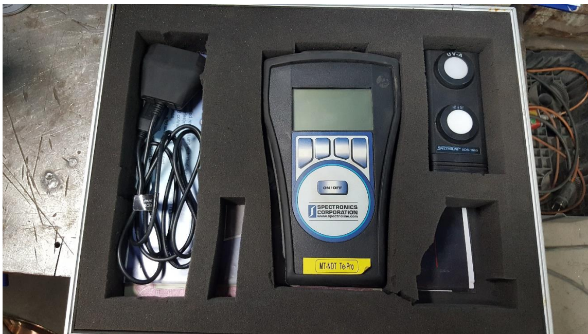
Slika 67: Lux metar SPECTROLINE XRP-3000
