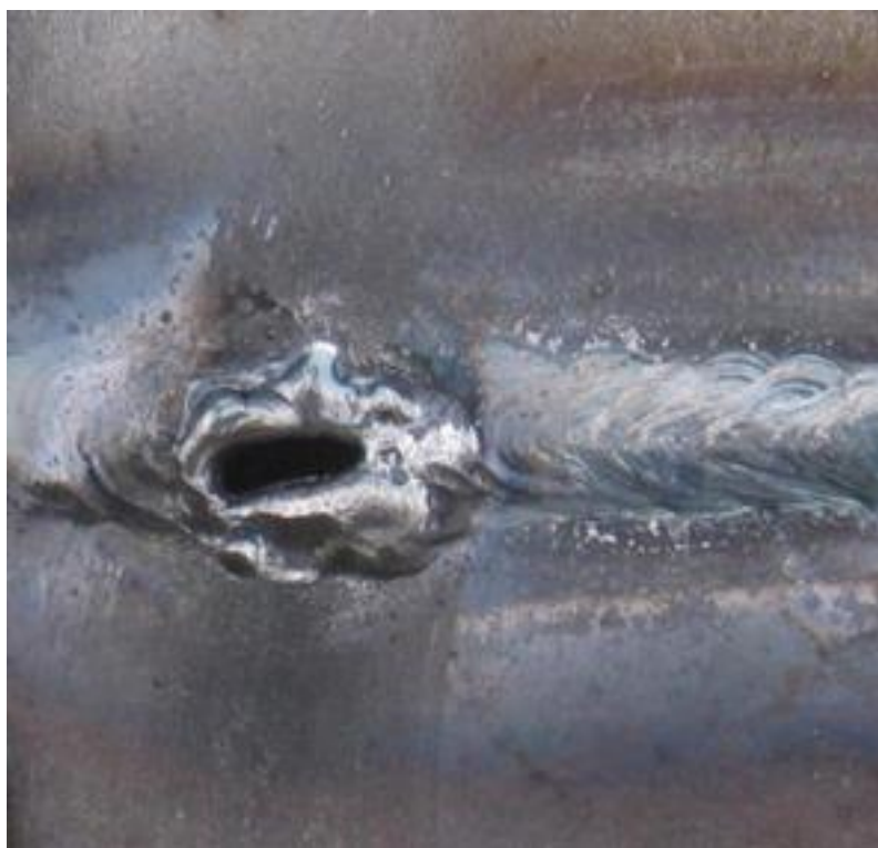
Slika 10: Šupljina u završnom krateru zavarenog spoja
