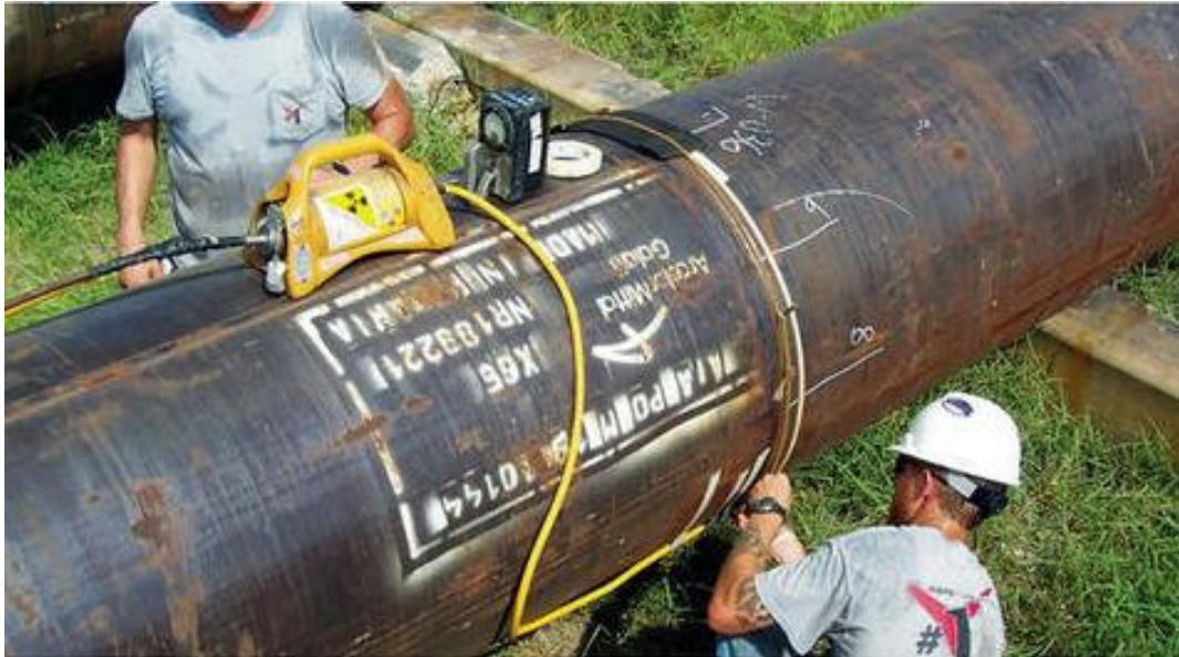
Slika 62: Radiografsko ispitivanje zavara na cjevovodu [21]
