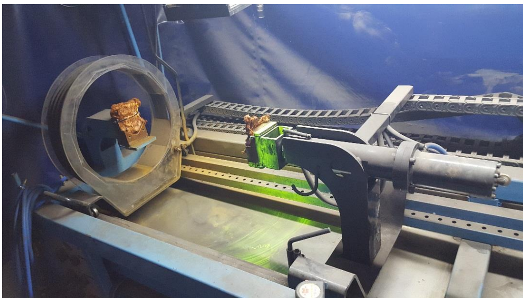
Slika 45: Po mjeri dizajnirana i izrađena „Magnetska bench naprava“
