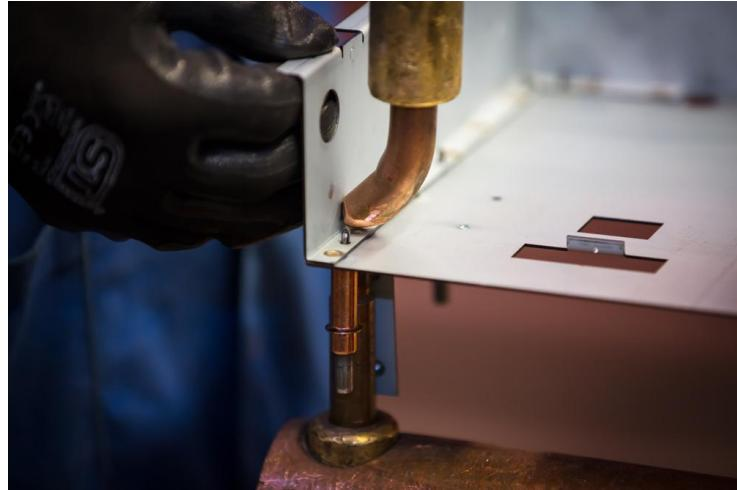
Slika 3.4 Zavarivanje pritiskom [14]
