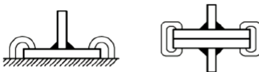
Slika 10.2 Smanjenje kutne deformacije [24]
