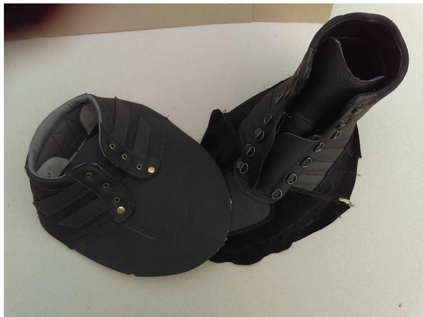
Slika 8 Spojeni i zašiveni dijelovi gornjišta cipela
