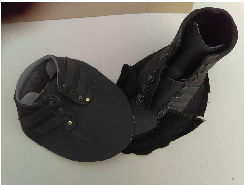
Slika 8 Spojeni i zašiveni dijelovi gornjišta cipela
