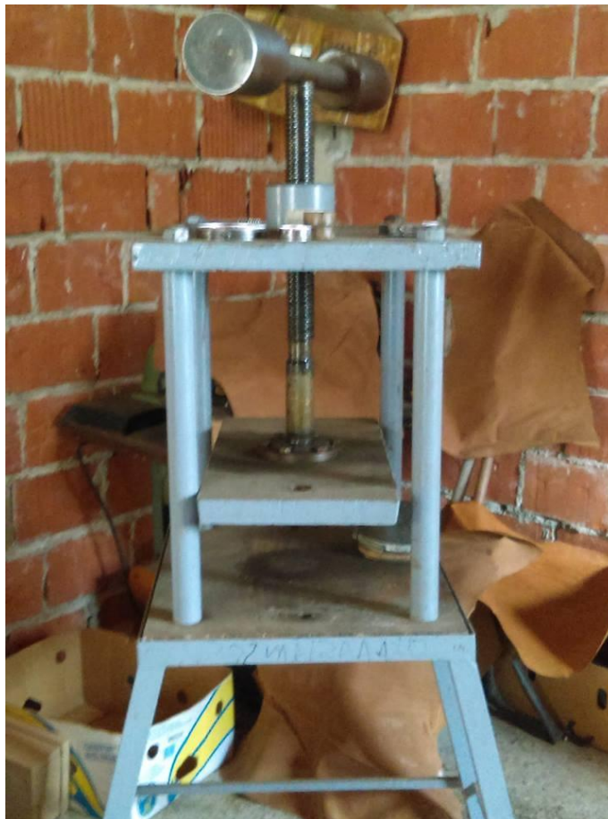
Slika 9 Ručna preša s kojom spajamo gornjište sa đonom
