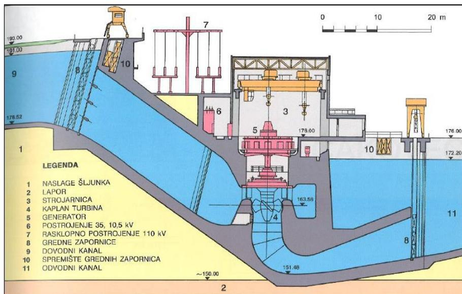
Slika 1.2. Poprečni presjek strojarnice HE Varaždin [2]
