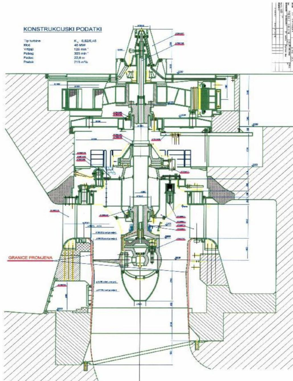
Slika 2.1. Presjek turbine s granicama promjene [2]
