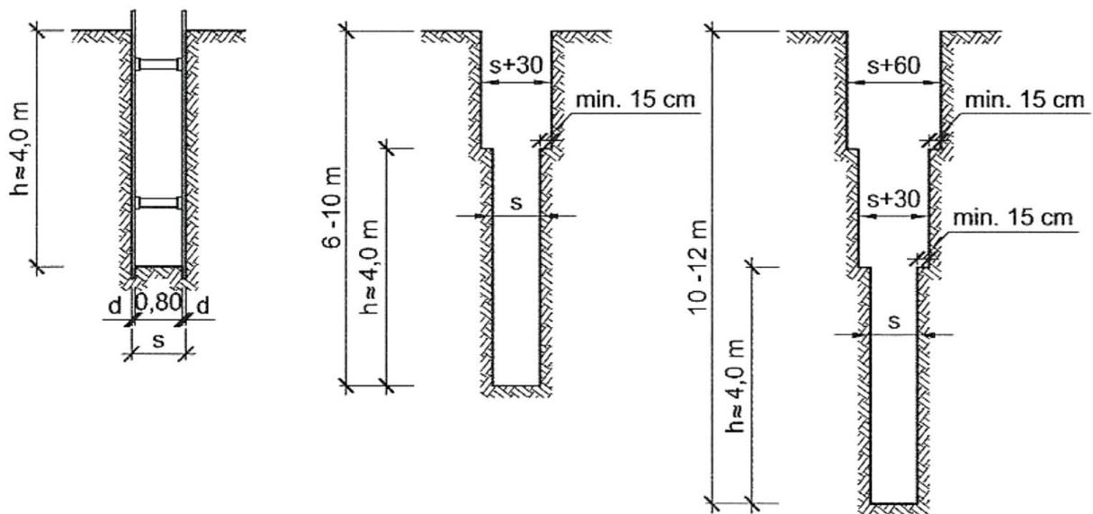
Slika 22. Širine drenažnog rova ovisno o dubini rova
