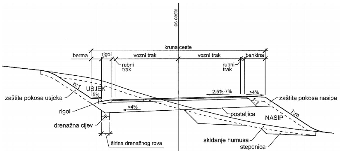
Slika 1. Osnovni elementi poprečnog presjeka ceste u zasjeku
