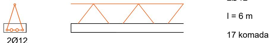
Okomito na smjer gredica u trecinama raspona izvesti ukrutna a. b. rebra armirana s  $4 \varnothing 14$ , te vilicama  $\varnothing 8/20\text{cm}$ . Armirani koševi duljine 3.1 m se preklapaju 40 cm.
