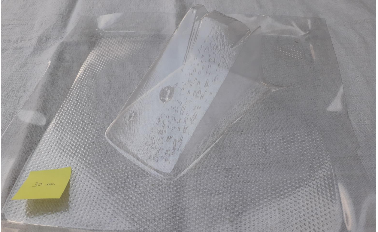
Slika 4.4 Drugi uzorak, t = 30 s, debljina folije = 0,3mm
