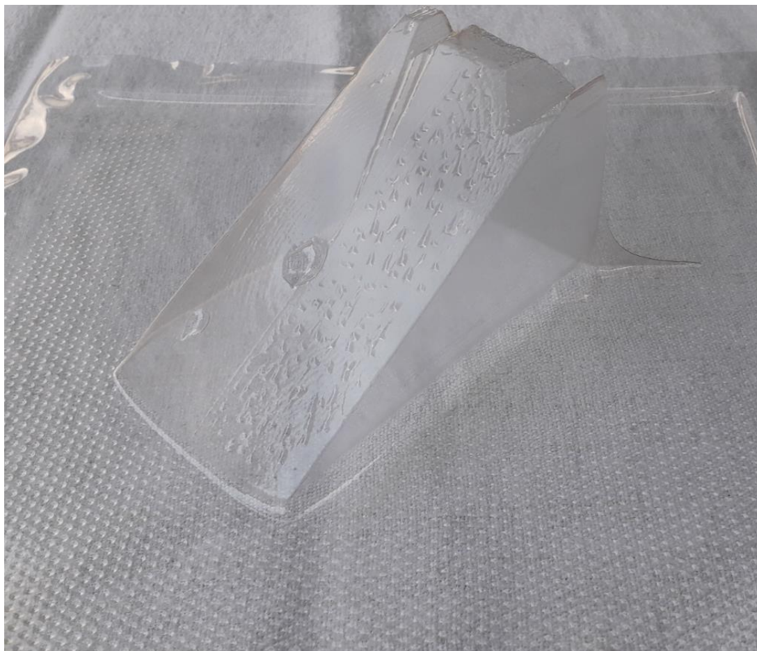
Slika 4.18 Peti uzorak, t = 300 s, debljina folije = 0,5mm
