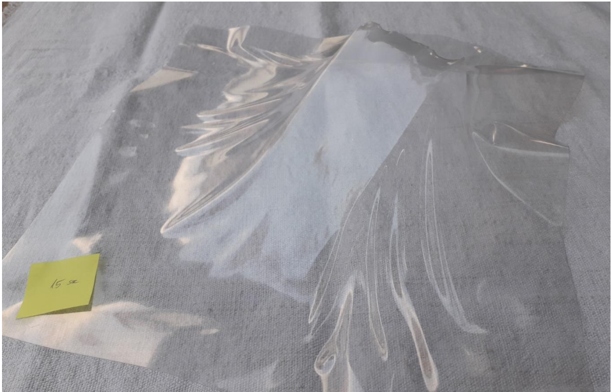
Slika 4.3 Prvi uzorak, t = 15 s, debljina folije = 0,3mm
