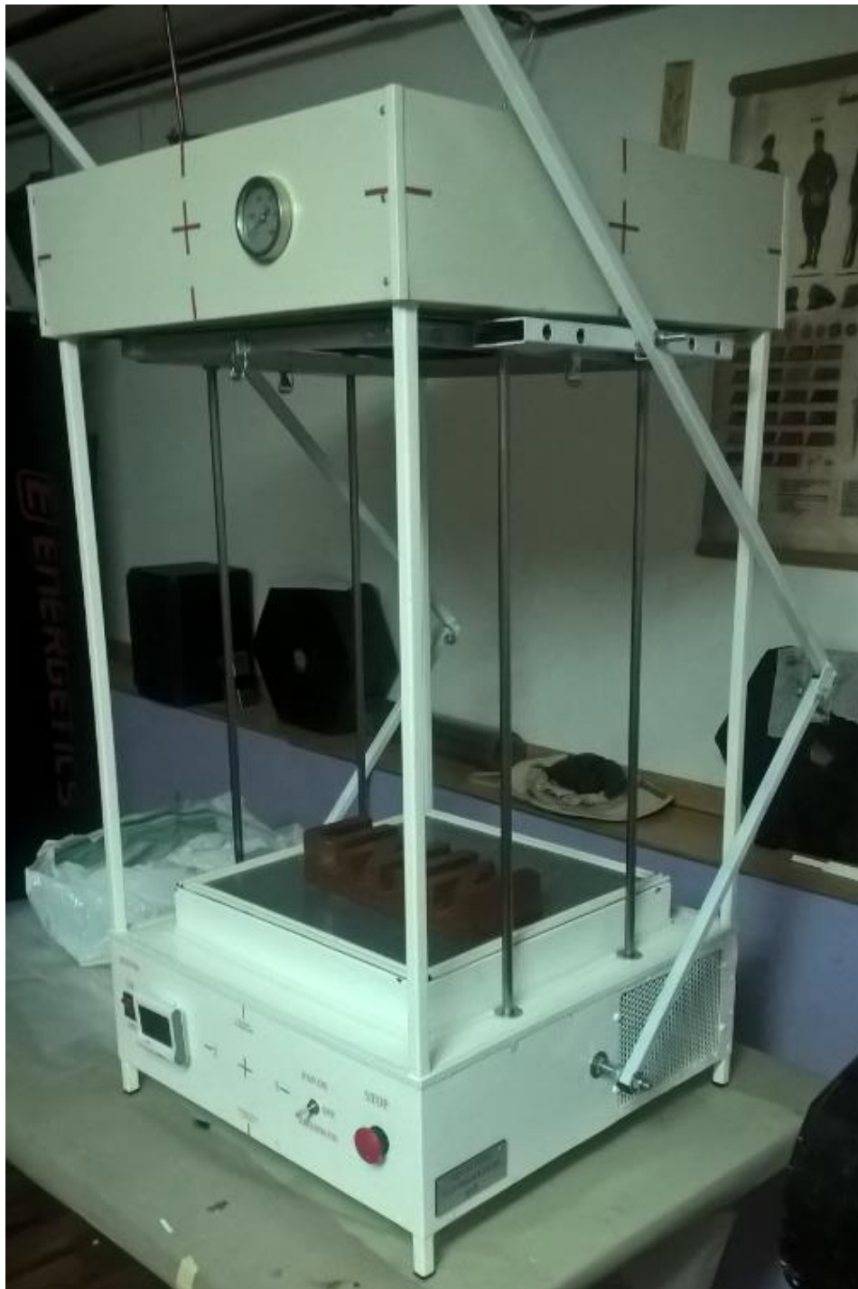
Slika 3.5 Uređaj za vakuumsko toplinsko oblikovanje polimera
