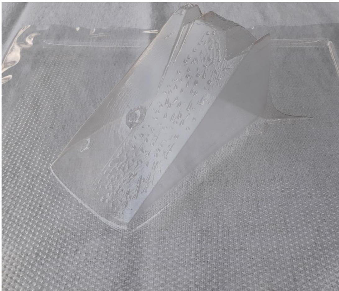
Slika 4.18 Peti uzorak,  $t = 300 \text{ s}$ , debljina folije = 0,5mm
