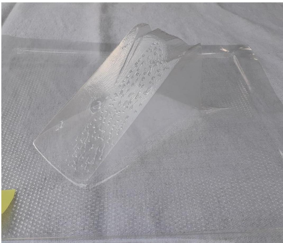
Slika 4.8 Šesti uzorak,  $t = 300$  s, debljina folije = 0,3mm
