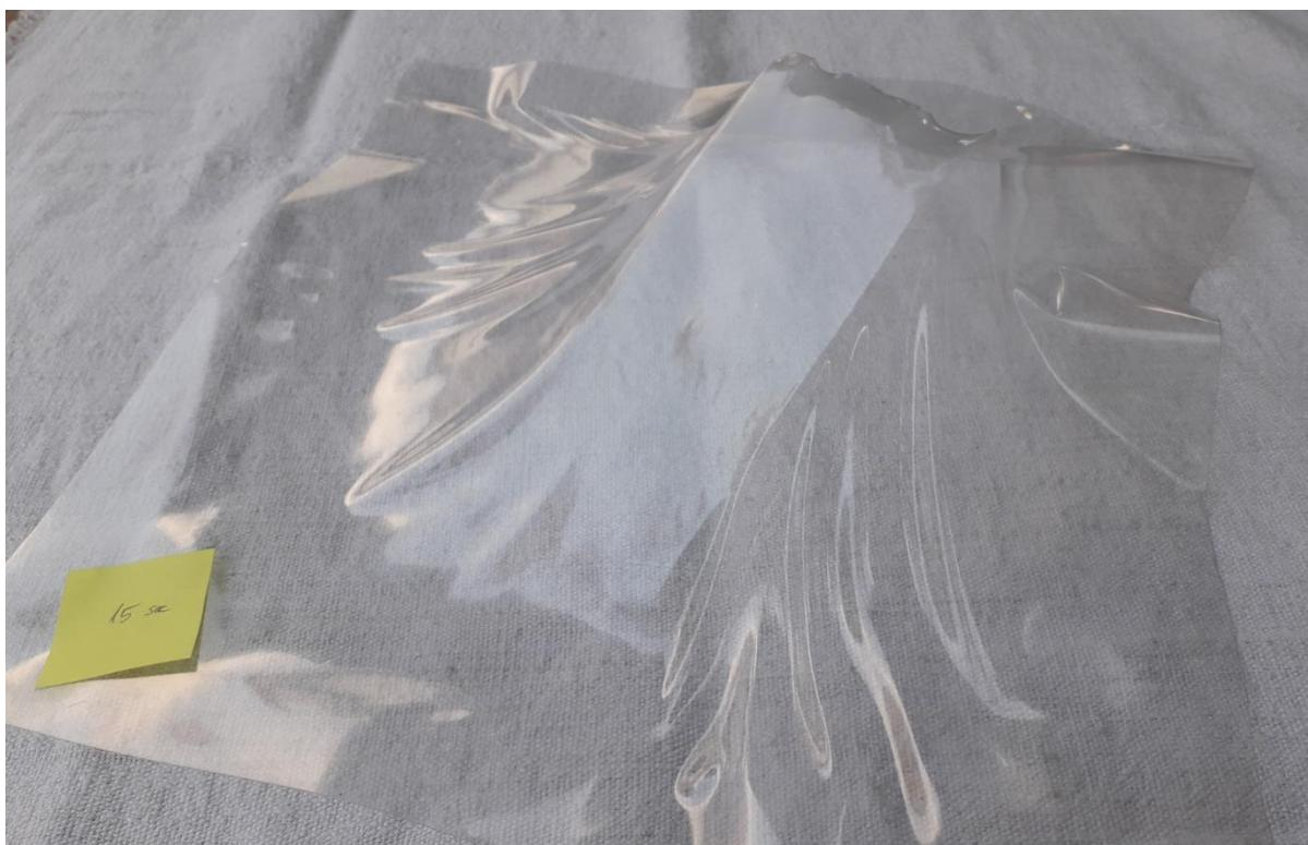
Slika 4.3 Prvi uzorak,  $t = 15 \text{ s}$ , debljina folije =  $0,3\text{mm}$
