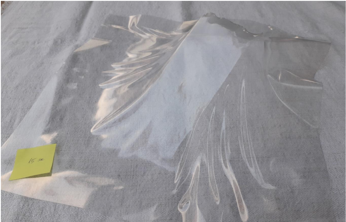
Slika 4.3 Prvi uzorak, t = 15 s, debljina folije = 0,3mm
