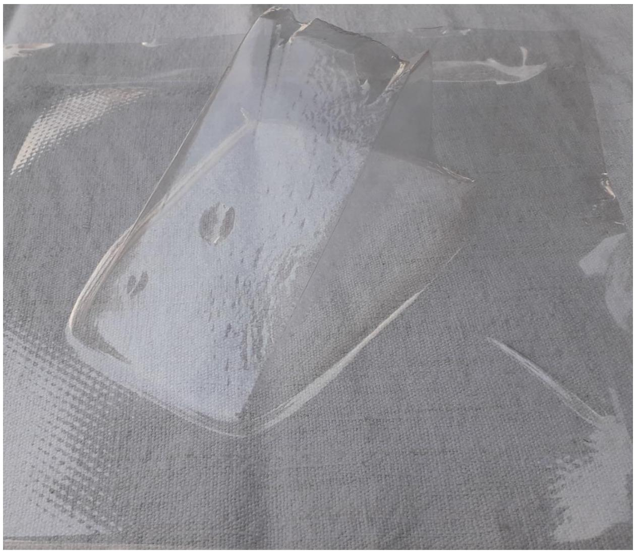
Slika 4.14 Prvi uzorak,  $t = 30$  s, debljina folije = 0,5mm
