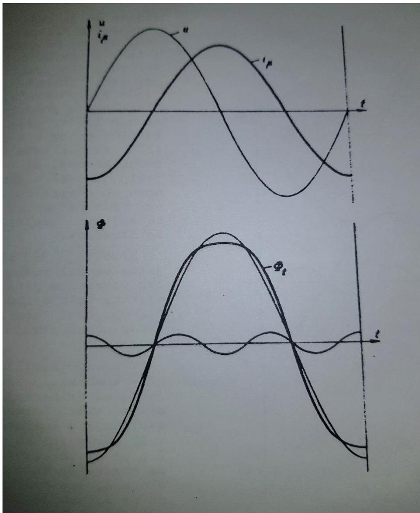
ispred transformatora, a tako deformirana krivulja se onda prenaša preko transformatora u sekundarnu mrežu.[2]
