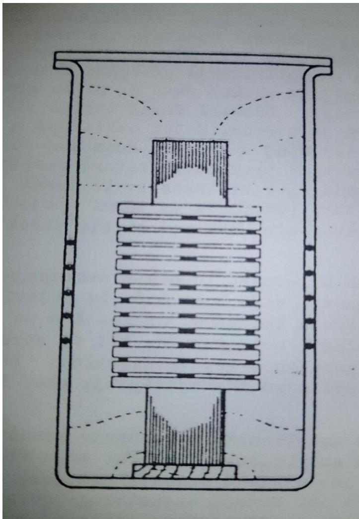
Slika 2.5.1. Uljni transformator[2]
