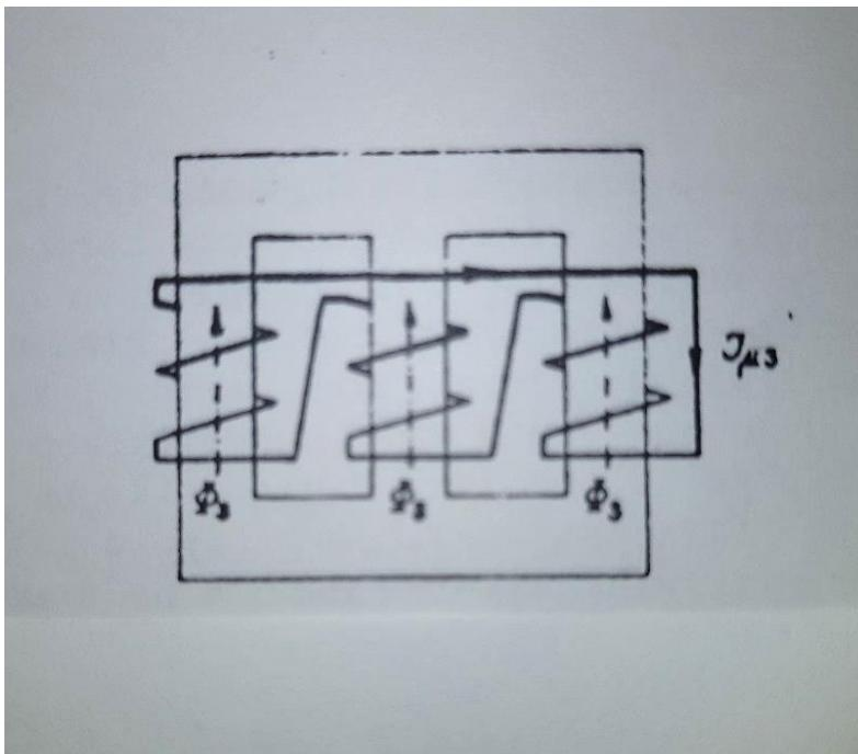
bi potpuno nestalo trećeg harmonika toka te bi imali opet potpuno prirodno magnetiziranje. Može se reći da se prisilno magnetiziranje kod primarnog spoja zvijezda bez nul-voda,a sekundarno zvijezda,može učiniti prirodnim,ako se doda na transformator tercijarni namot jer će se sada potrebni treći harmonički valovi struje pojaviti kao struja kratkog spoja u ovom zatvorenom namotu.[2]
