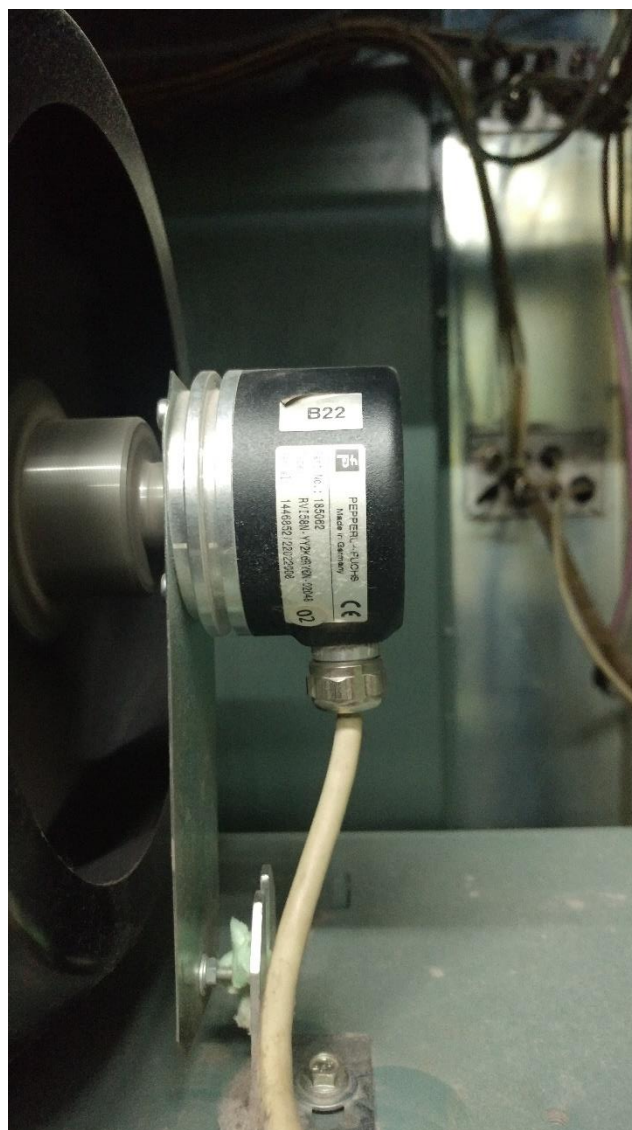
Slika 5.7. Enkoder na osovini elektromotora
