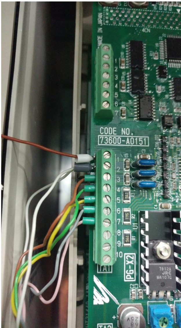
Slika 5.6. Upravljački modul frekventijskog pretvarača
