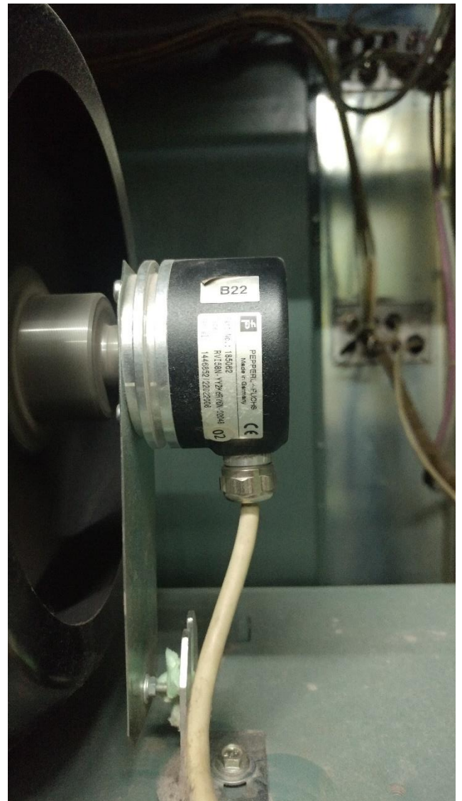
Slika 5.7. Enkoder na osovini elektromotora
