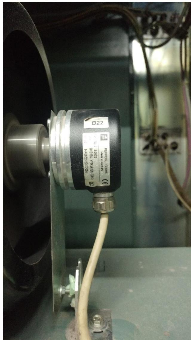
Slika 5.7. Enkoder na osovini elektromotora
