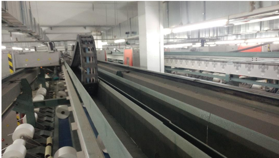
Slika 6.7. Kanali po kojim putuju energetske lanci
