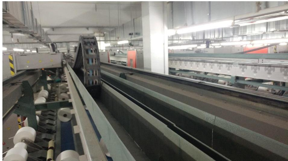
Slika 6.7. Kanali po kojem putuju energetske lanci
