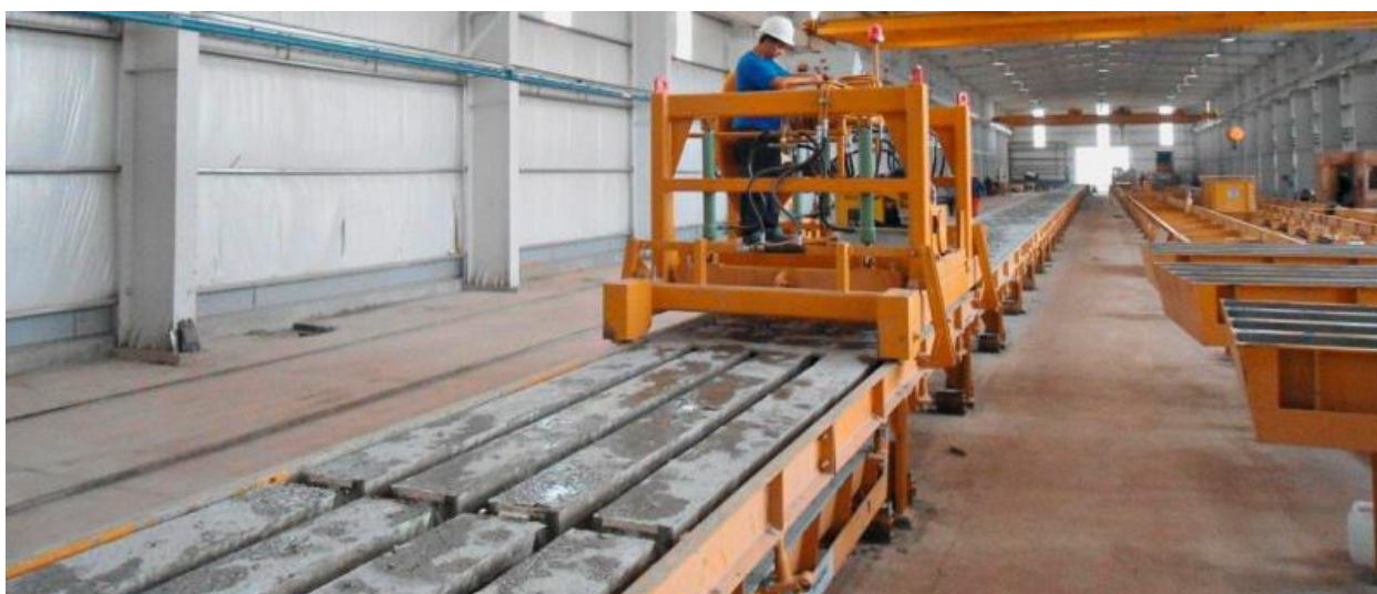
Slika 4.8 Kontrola predgotovljenih betonskih elemenata
