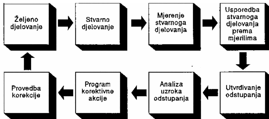
Slika 4: Povratna veza upravljačke kontrole
