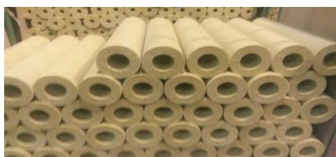
**Slika 20:** Izolacijski cijevaci
