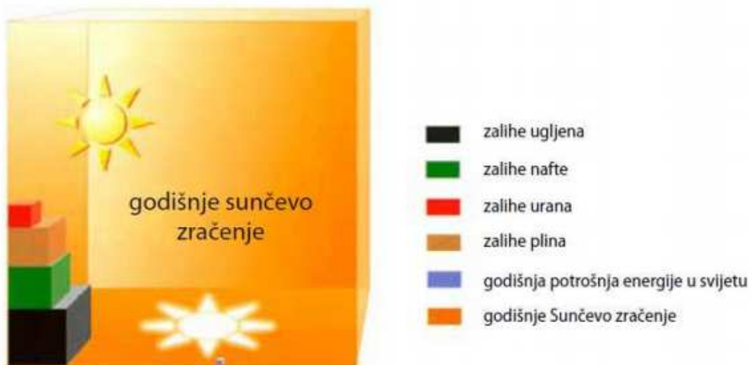
Slika 1.1. Godišnje sunčevo zračenje na površini zemlje u usporedbi s godišnjom potrošnjom energije u svijetu te svjetskim zalihama fosilnih i nuklearnih goriva
