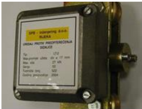
Slika 3.16: Uređaj protiv preopterećenja dizalice [5]
