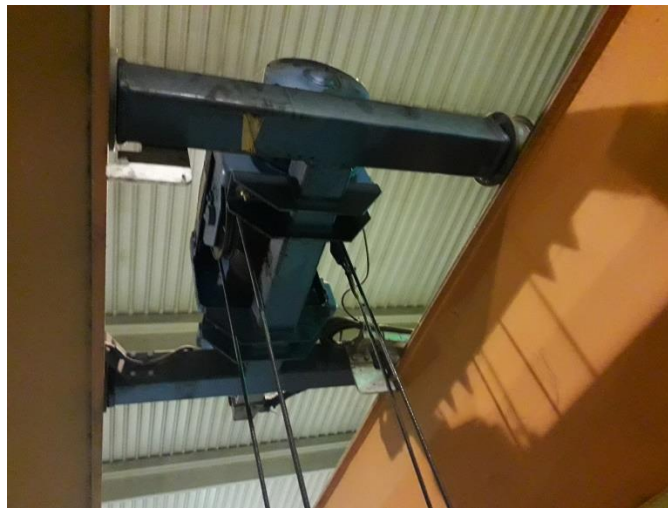
Slika 4.2: Transportni sklop dvotračne mosne dizalice [20]
