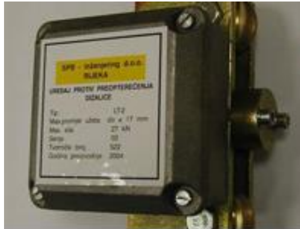
Slika 3.16: Uređaj protiv preopterećenja dizalice [5]
