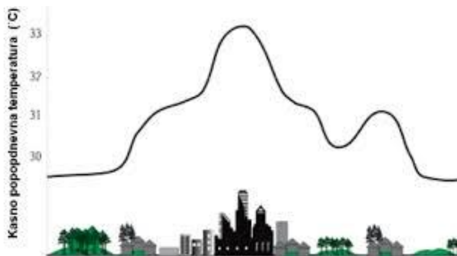
Slika 4.2.1.1. Shematski prikaz promjene temperature (izvor: S. Babić, A. Deluka-Tibljaš, M. Cuculić, S. Šurdonja: „Analiza zagrijavanja kolničkih površina urbanih područja“, časopis Građevinar 64 (2012) 2, str. 125.)
