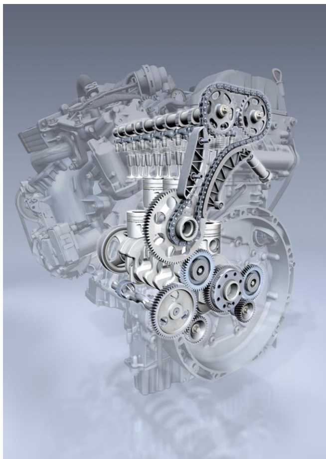
Slika 16. Pogon bregastog vratila lancem [30]
