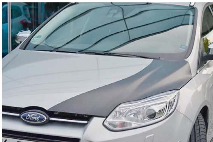
Slika 44. Fordov poklopac motora ojačan ugljikovim vlaknima [3]
