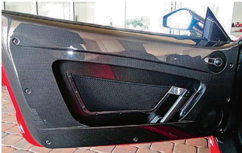
Slika 45. Paneli vrata od plastomerne matrice ojačane ugljikovim vlaknima [3]
