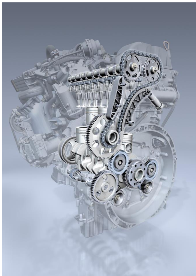
Slika 16. Pogon bregastog vratila lancem [30]
