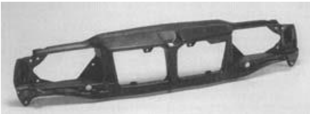
Slika 23. Prednji dio Volva 850, PP ojačan staklenim vlaknima [11]
