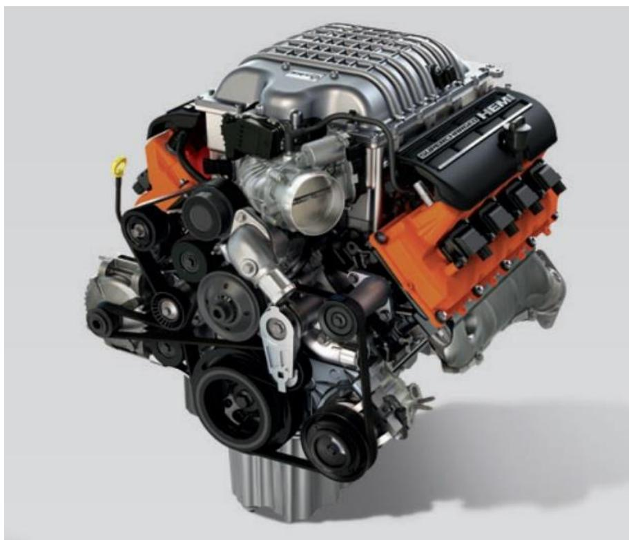
Slika 34. Mehanički pogon kompresora [18]
