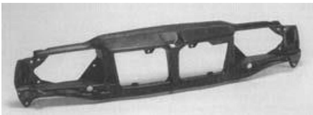
Slika 23. Prednji dio Volva 850, PP ojačan staklenim vlaknima [11]
