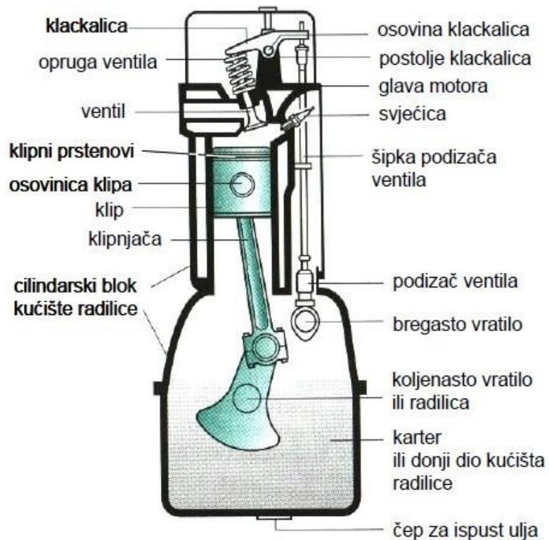
Slika 4. Poprečni presjek 4T-motora [22]
