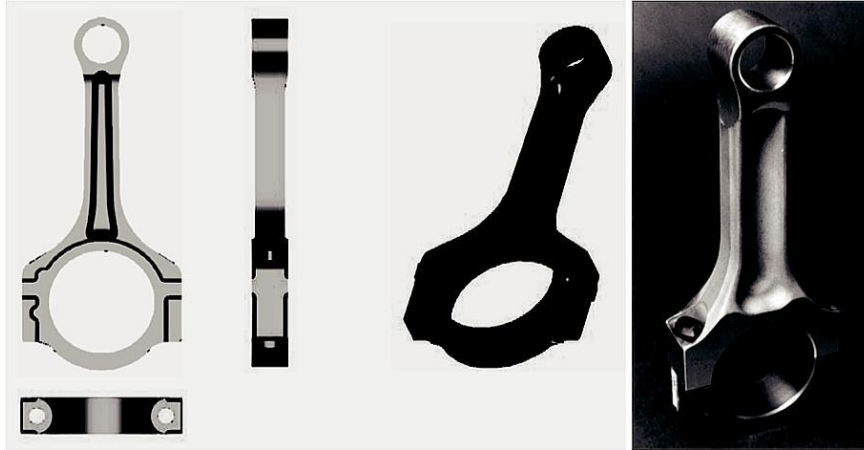
Slika 28. Klipnjača od aluminijskog MMC-a [15]
