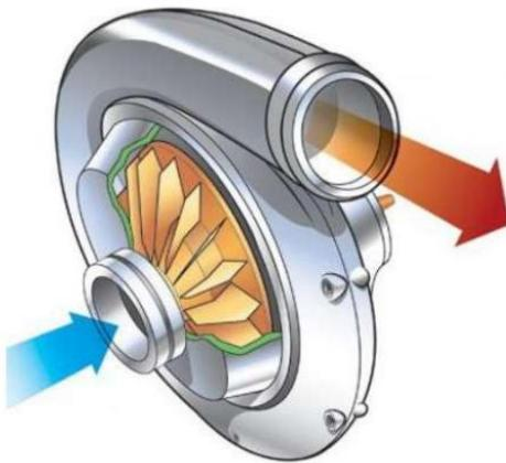
Slika 36. Centrifugalni kompresor [31]
