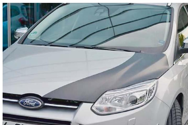
Slika 44. Fordov poklopac motora ojačan ugljikovim vlaknima [3]
