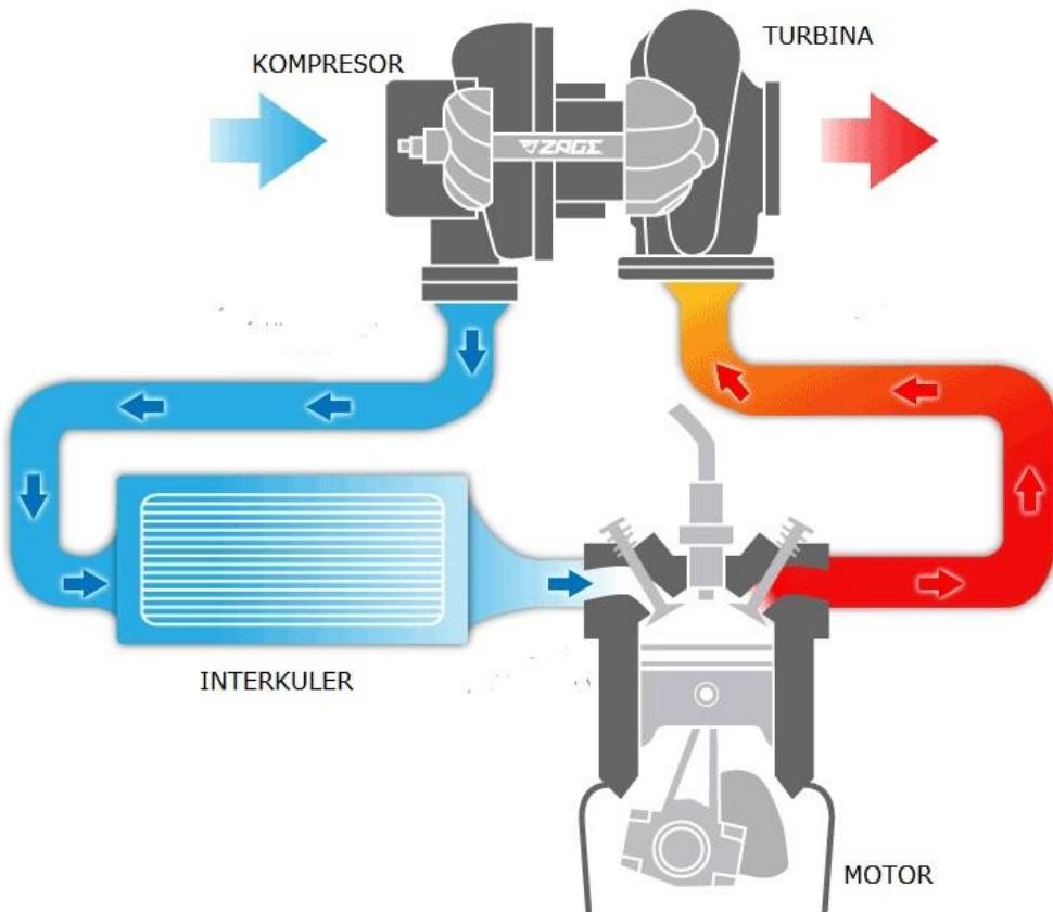
Slika 35. Princip rada turbopunjača [26]
