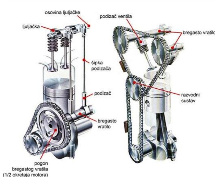
Slika 5. Bregasto vratilo u bloku motora (lijevo) i sustav upravljanja ventilima s dva bregasta vratila u glavi motora [23]
