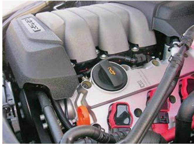
Slika 48. Poklopac glave motora kod motora 3,2 FSI [3]
