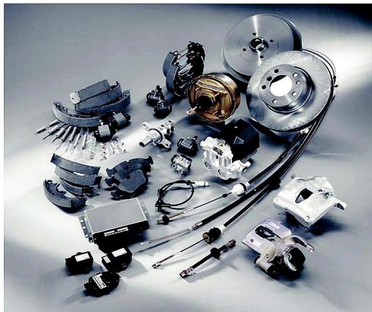
Slika 30. Kočioni sustav izrađen od aluminijskog MMC-a [15]
