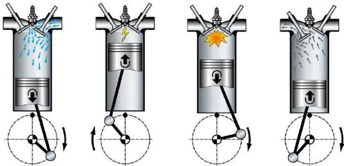
Slika 3. Četiri takta u 4T-motoru: usis, kompresija, ekspanzija, ispuh [22]
