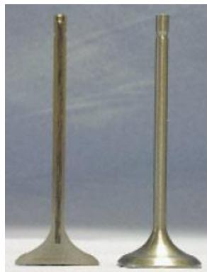
Slika 29. Ventili automobilskog motora [10]
