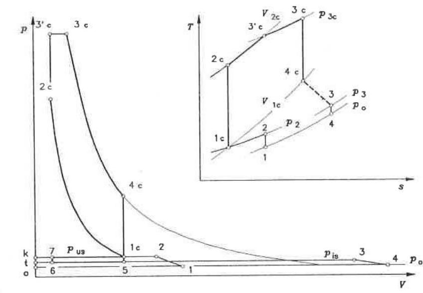
Slika 37. Proces u cilindru, kompresoru i plinskoj turbinii [17]
