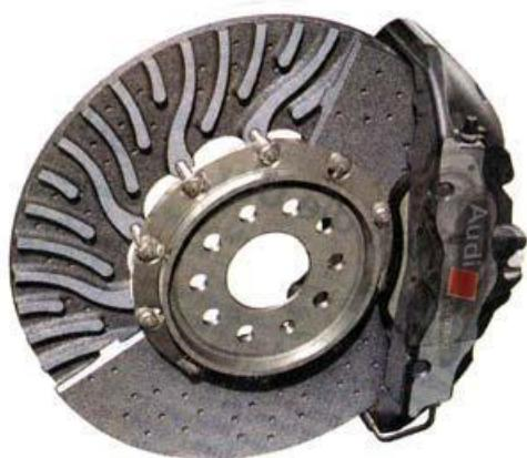
Slika 39. Keramički kompozitni disk [16]
