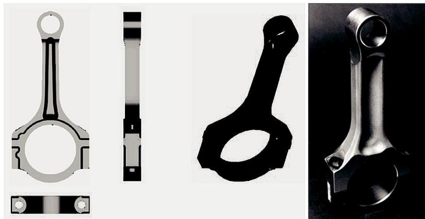
Slika 28. Klipnjača od aluminijskog MMC-a [15]
