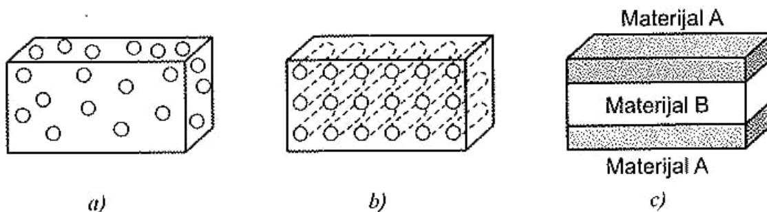
Slika 20. Osnovni tipovi kompozita prema obliku ojačala: a) kompozit s česticama, b) kompozit s vlaknima, c) slojeviti kompozit [1]
