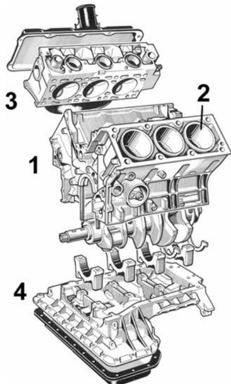
Slika 12. Kućište automobilskoga motora iz 1980-ih [5]. Kućište radilice (1), cilindar (2), glava cilindra (3) i uljno korito (4). [5]
