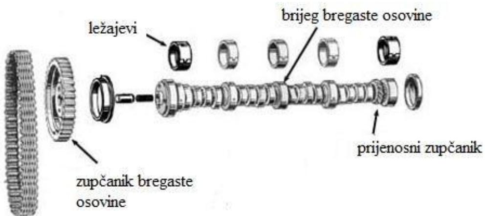
Slika 13. Dijelovi bregastog vratila [28]
