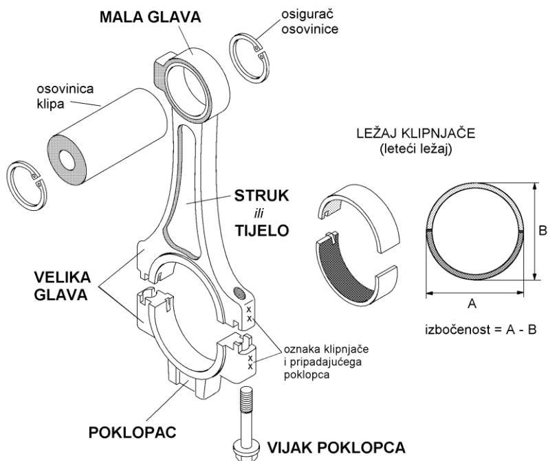
Slika 8. Dvodijelna klipnjača s poklopcom kamionskih Dieselovih motora tvornice MAN [5]
