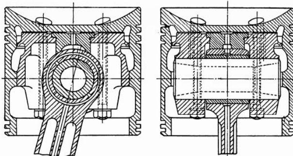
Slika 6. Višedijelni klip [5]. Kod opterećenijih Dieselovih motora gornji se dio, odnosno čelo klipa izrađuje od kovanog čelika ili SL te se spaja vijcima na donji dio od specijalnog SL ili Al-legure. Višedijelni klipovi većinom imaju i posebno hlađenje uljem. Kod klipa na slici ulje za hlađenje dovodi se kroz šuplju klipnjaču neposredno na donju stranu čela [5]
