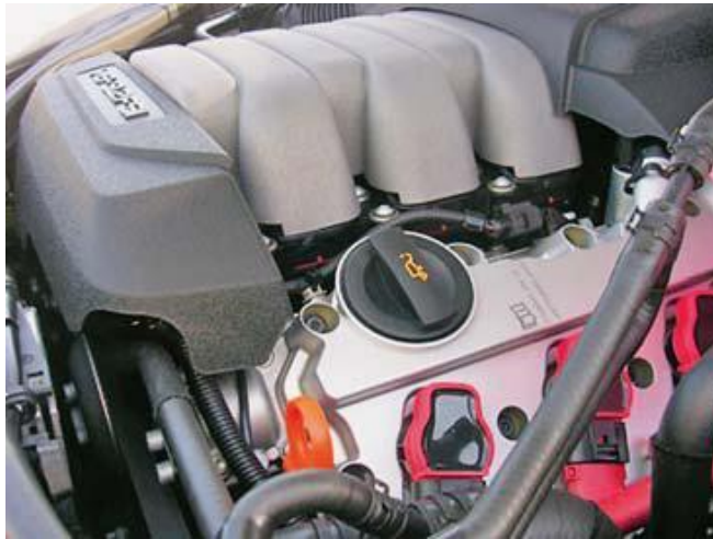
Slika 48. Poklopac glave motora kod motora 3,2 FSI [3]
