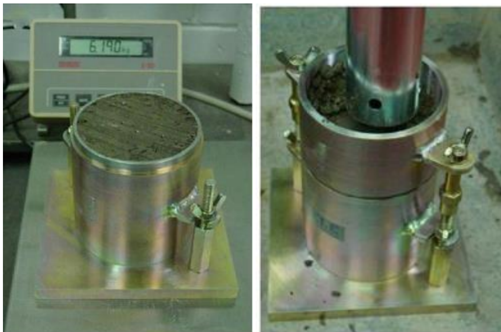
Slika 4.6. Zbijanje Proctorovim aparatom
