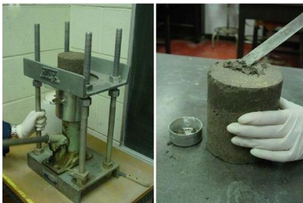
Slika 4.7. Završna obrada uzorka
