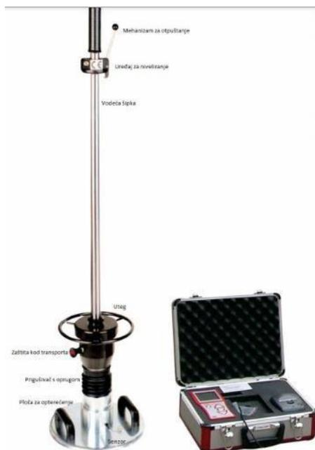
Slika 4.12. Dinamička kružna ploča
