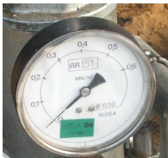
Slika 4.10. Manometar za očitavanje tlaka
