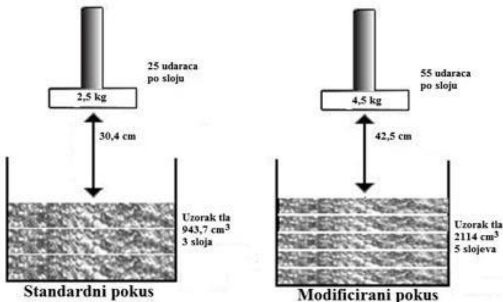
Slika 4.8. Shematski prikaz zbijanja uzorka Proctorovim aparatom
