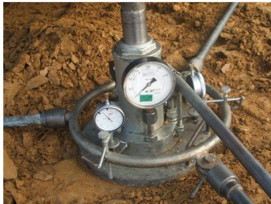
Slika 4.9. Statička kružna ploča
