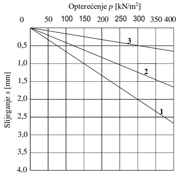
Slika 4.11. Dijagram za određivanje stupnja nosivosti
