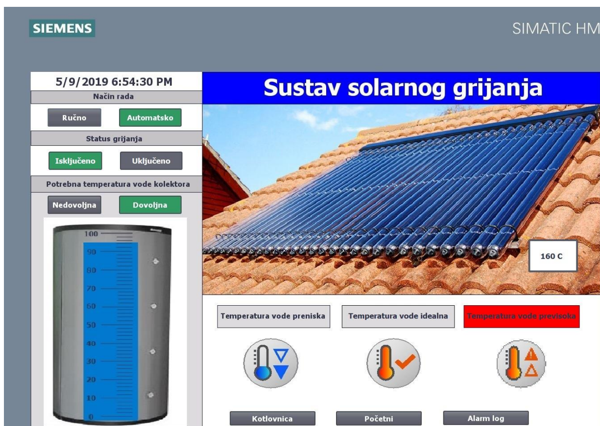
Slika 5.10 Isključivanje sustava radi prevelike temperature
