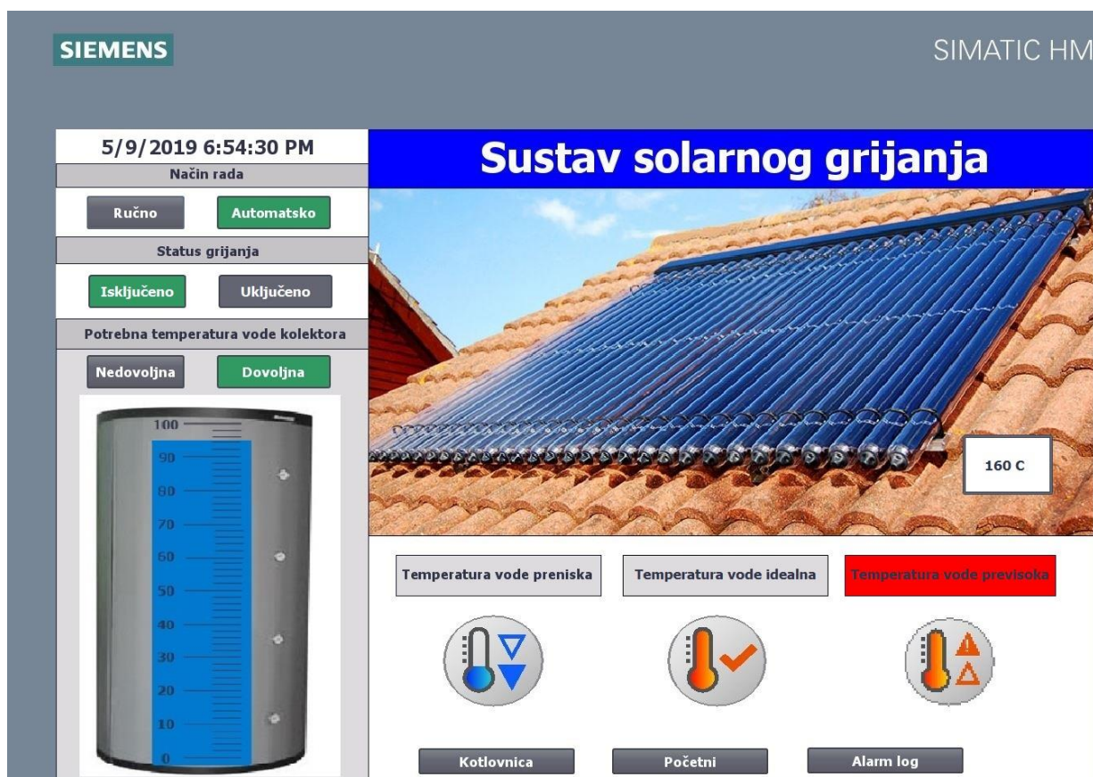
Slika 5.10 Isključivanje sustava radi prevelike temperature
