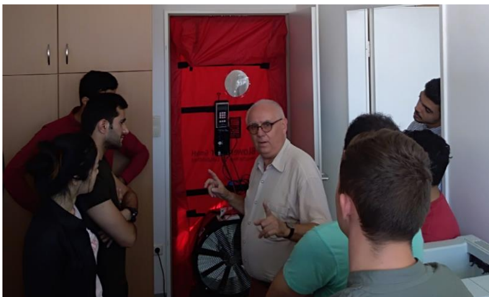
Slika 2.4 Praktični dio nastave, testiranje sa opremom za puhanje [5]
