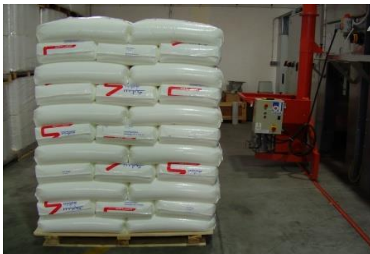
Slika 3. sirovina (LLDPE granulat)
