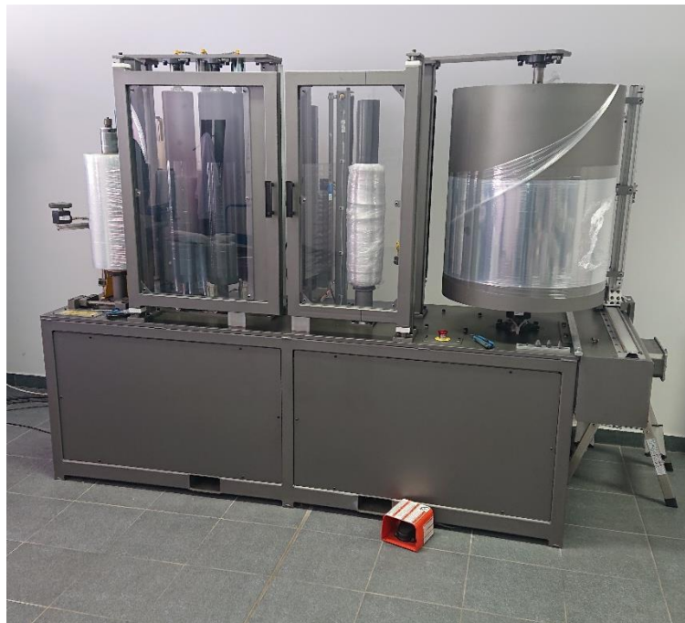
Slika 28. uređaj za testiranje stretch folija
