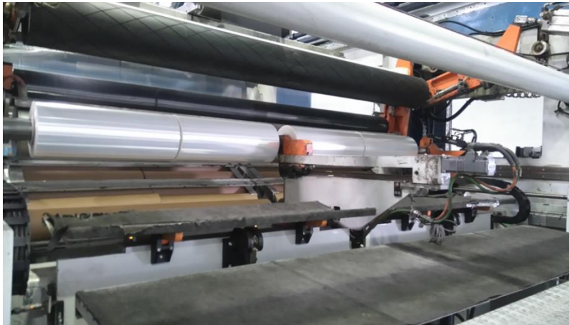
Slika 16. namatanje stretch folije na tuljke
