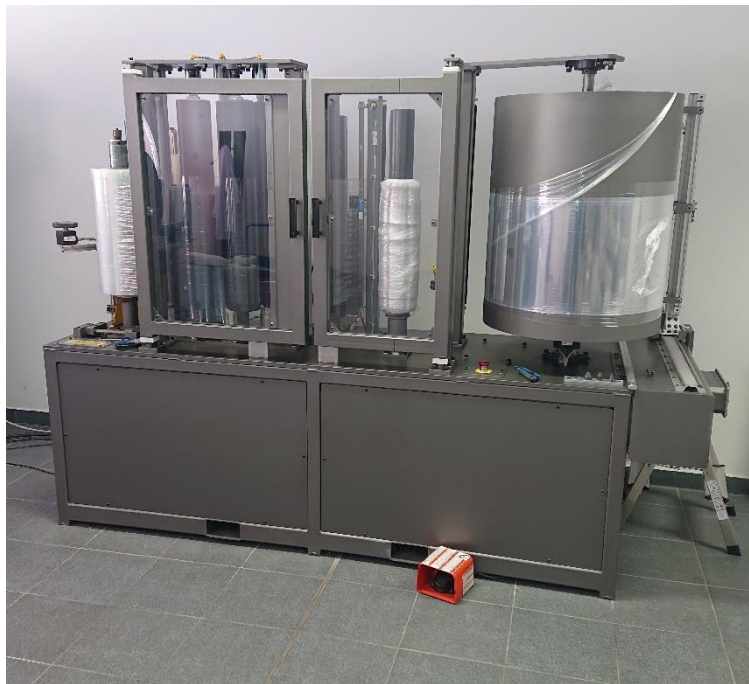
Slika 28. uređaj za testiranje stretch folija
