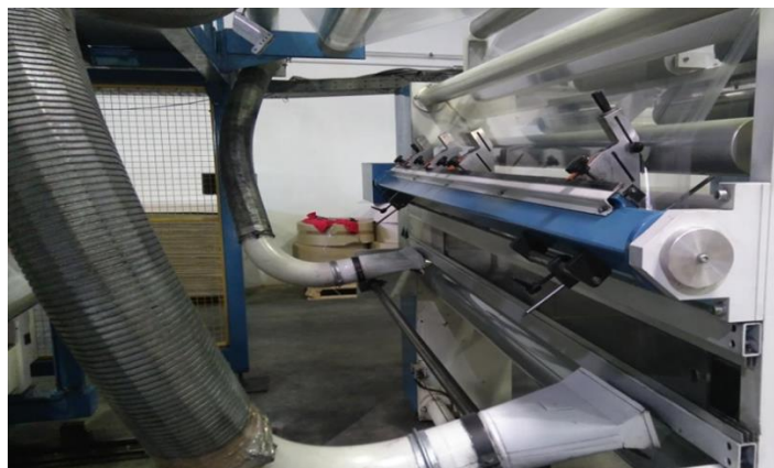
Slika 14. zatezanje, rezanje i namatanje stretch folije
