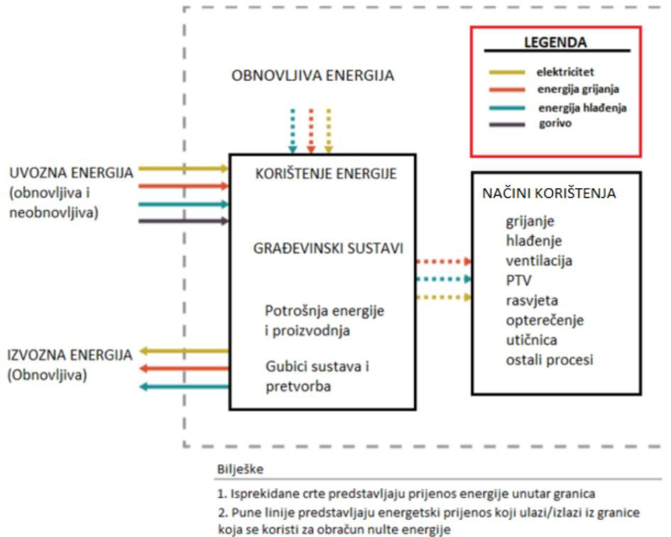
Slika 14: Način prijenosa energije za obračunavanje nulte energije
