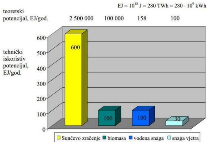
Slika 10: Teoretski i tehnički potencijal obnovljivih izvora energije
