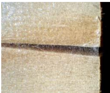
Slika 3.2. Otvaranje pukotina u uzorku drva nakon cikličkog ispitivanja
